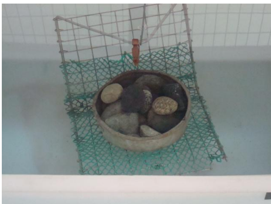
Ensayo para sacar la porosidad del medio granular
