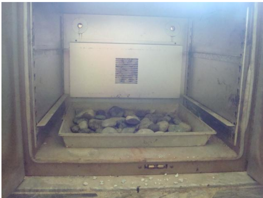
Horno para secado de la muestra de medio granular
