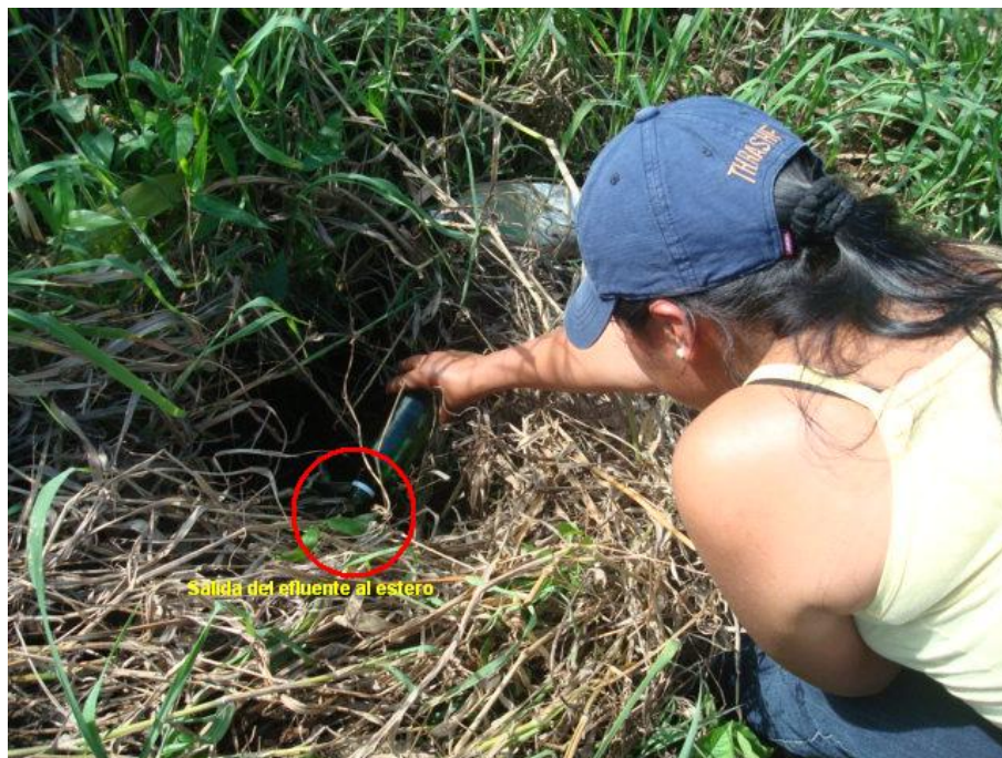
Figura 3.12.: Toma de muestra del efluente
