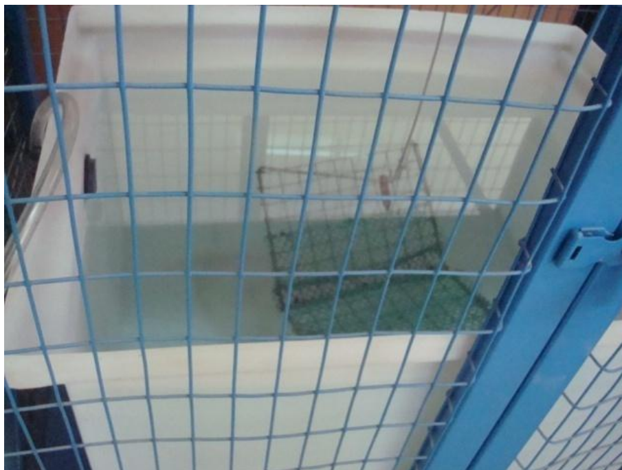
Equipo para sacar la porosidad del medio granular
