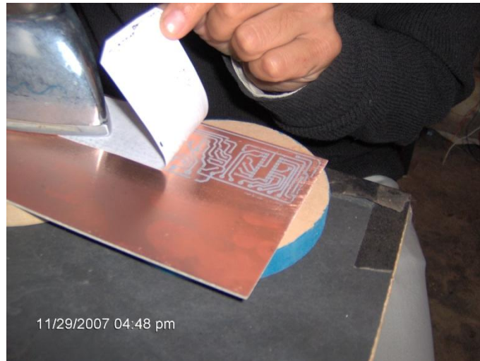
Figura 3.33 Plasmando en circuito en la baquelita
