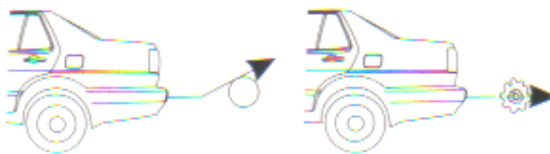
Figura 4.24 Tipos de objetos donde se pierde la señal de eco del sensor
