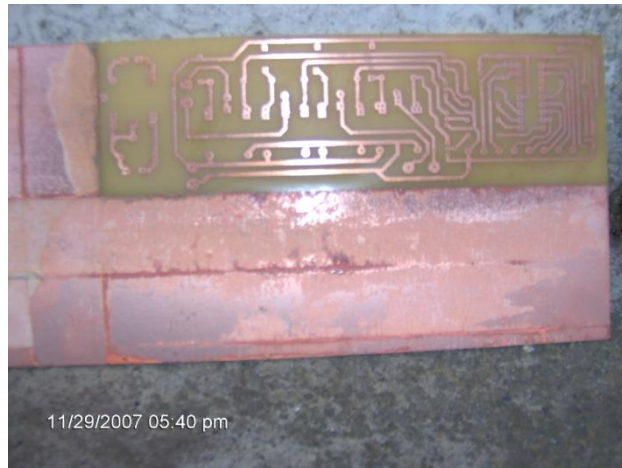
Figura 3.35 Aplicación de ácido a la baquelita con las pistas
