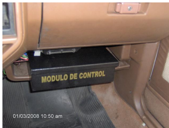
Figura 3.38 Caja metálica para las placas en el vehiculo
