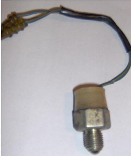
Figura 2.20 Interruptor de posición de reversa (NA)
