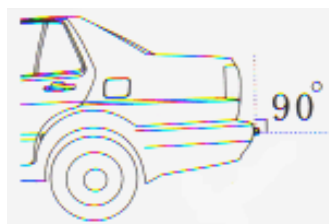
Figura 3.40 Correcto ángulo de los sensores
