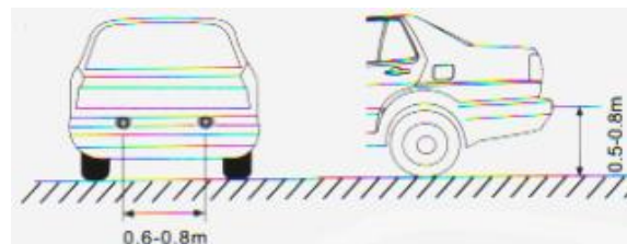
Figura 3.41 Rango de distancias para evitar lecturas erróneas
