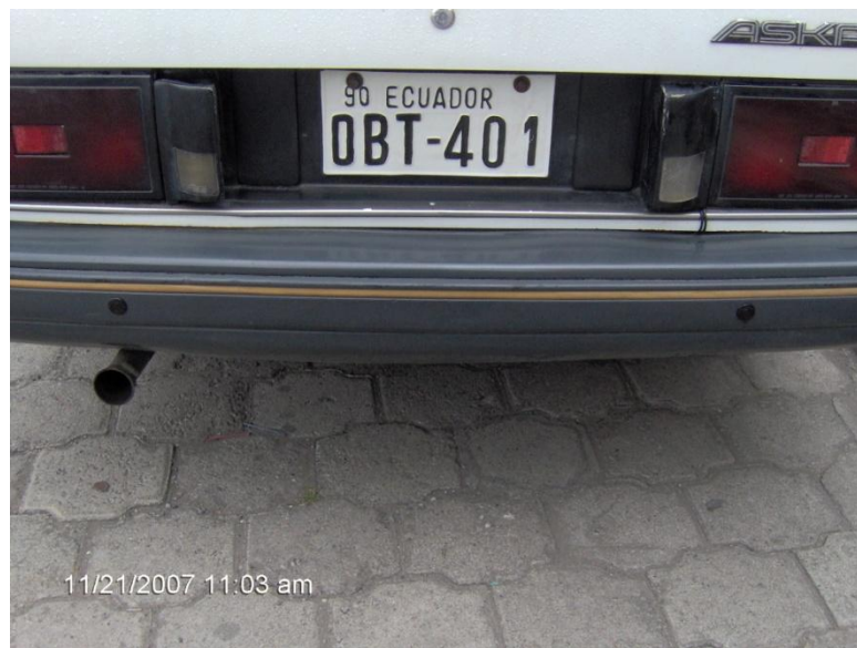
Figura 3.42 Sensores colocados en el guarda choque posterior
