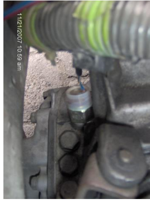
Figura 3.18 Pulsador de la posición de reversa ( NA )
