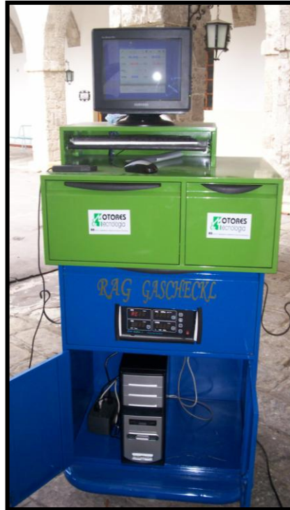
Figura 3.9 Analizador de gases (Fuente: Laboratorio Mecánica de Patio E.S.P.E.L.) Método de medición: Infrarrojo no dispersivo (CO, CO 2 , HC) Sensores electroquímicos (O 2 , NO x )
