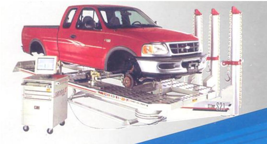
**Fig. 1.7.7.3 Banco de enderezada electrónico Génesis**
