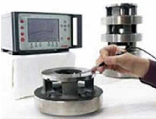
Fig. 2.25 – 2.26. Equipo de corrientes Eddy y gráfica de resultados en el PC
