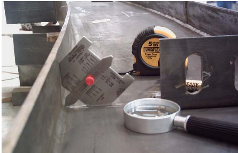
Fig. 2.12. Instrumentos utilizados en inspección visual de soldadura
