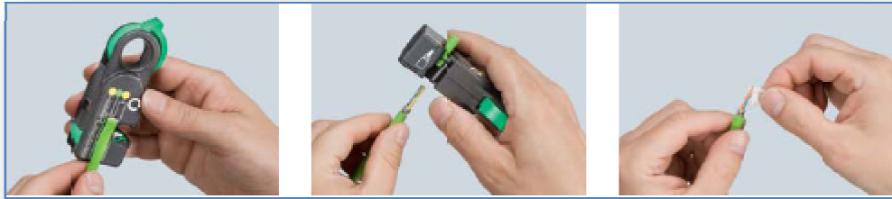
FIGURA 2.10.PELADO DEL CABLE PROFIBUS
