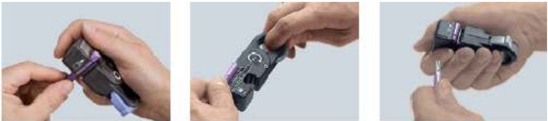
FIGURA 2.8.PELADO DEL CABLE PROFIBUS
