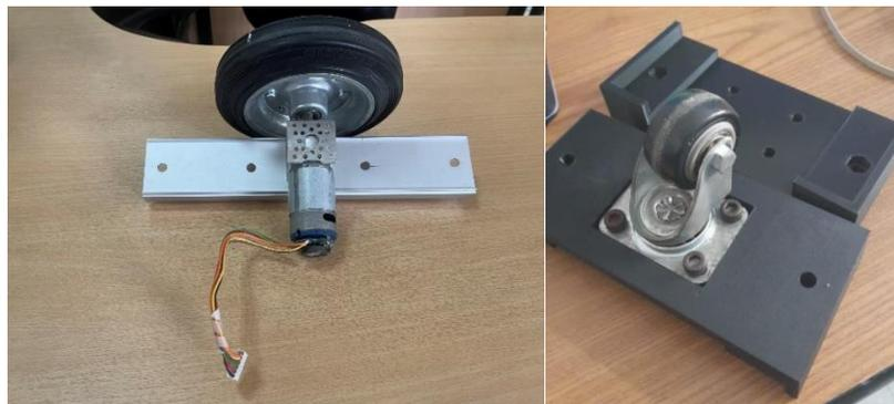
En la **Figura 99** se montan los perfiles a la estructura con las llantas de tracción, y se unen mediante pernos m6, tuercas y arandelas. Adicional unas piezas triangulares en la base de la estructura aprisionan el perfil para que se obtenga una mayor rigidez en el perfil que trabajará como una viga doblemente apoyada.
