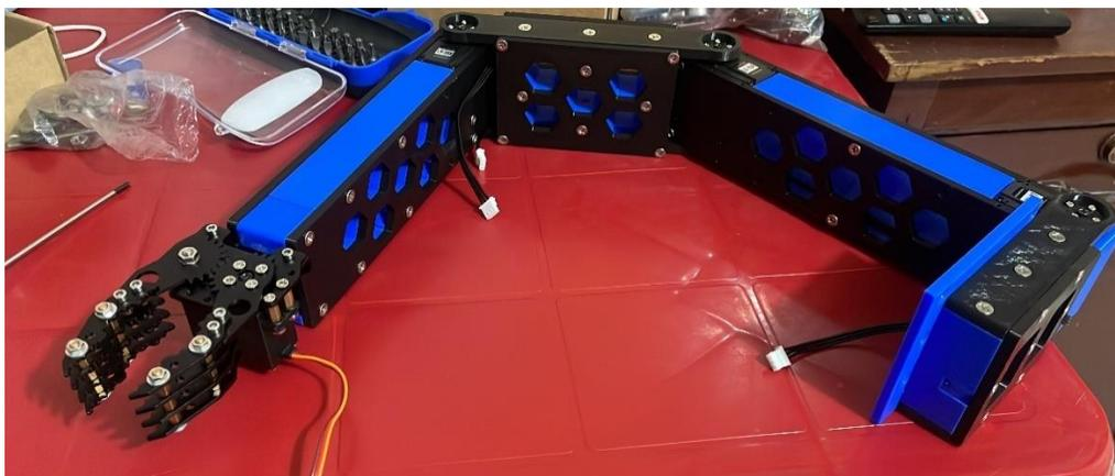
Teniendo armada la estructura por completo del robot, se acopla el brazo articulado a la base móvil superior. Se realizan las conexiones de los actuadores de las articulaciones y todo el cableado de potencia. Los cables se conectan de la base diferencial a la base móvil superior mediante en una cadena guía porta cables de plástico.
