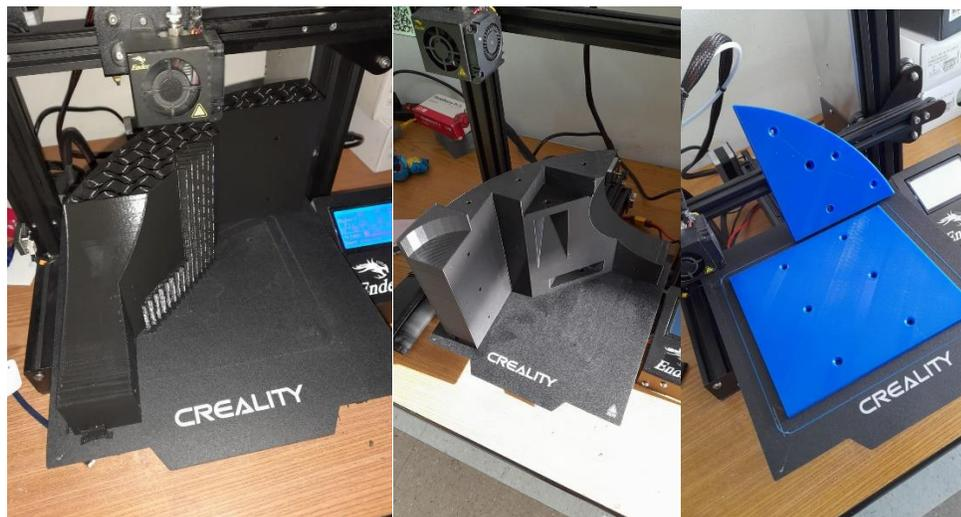
Luego de tener impresas las piezas contorno de la base y sus partes de unión, se procede a ensamblar y unir mediante tornillos autorroscantes de cabeza avellanada, logran obtener la base que se muestra en la siguiente Figura.
