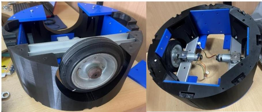
Finalmente se ensambla la base de batería con las ruedas locas mediante pernos m7 y se posiciona la base central que soportará el nuevo perfil de aluminio. En la siguiente Figura puede ver el ensamble total de la parte baja de la base del robot.
