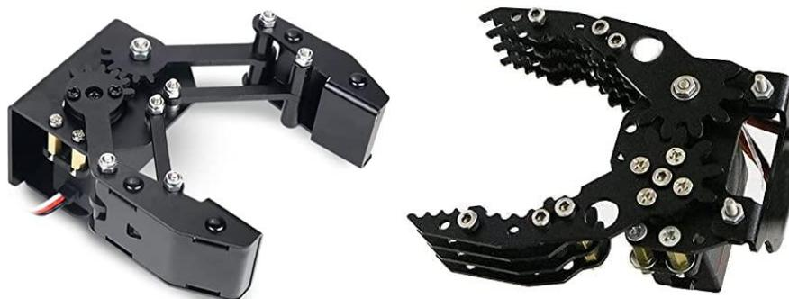
*Nota:* a) LewanSoul Pinza mecánica BigClaw, b) G6 Pinza mecánica de garra robótica
