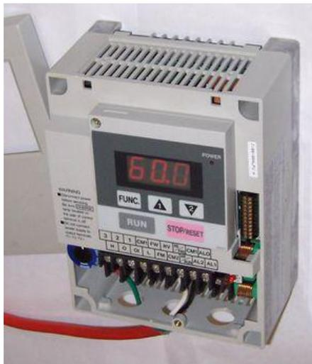
**Figura 1.8.** Pequeño dispositivo variador de frecuencia (VFD)
