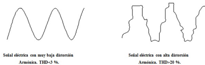
Figura 1.7: Influencia de la distorsión armónica en la señal eléctrica.
