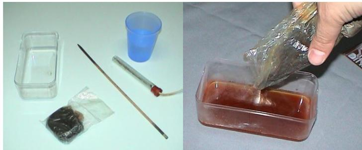
**Fig.5.7 Materiales a utilizar, y a la derecha mezcla del cloruro férrico con el agua**
