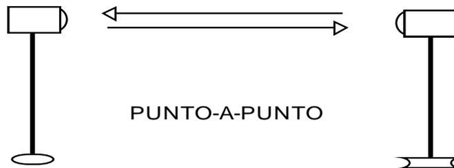
**Fig. 2.5 Transmisión infrarrojo punto a punto**
