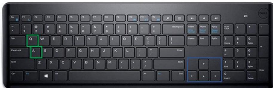
También funciona mediante un control inalámbrico conectado mediante Bluetooth, para esto utiliza la misma disposición de teclas las teclas en verde para el control de velocidad y las teclas en azul para el movimiento del robot en el plano.
