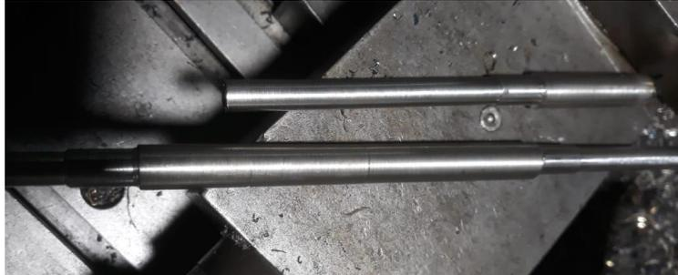
Mientras que el material que se utilizó para la manufactura de los ejes del diferencial es Acero AISI 304 de 10mm de diámetro. Los engranajes cónicos y los ejes se los ensambla como se muestra en la
