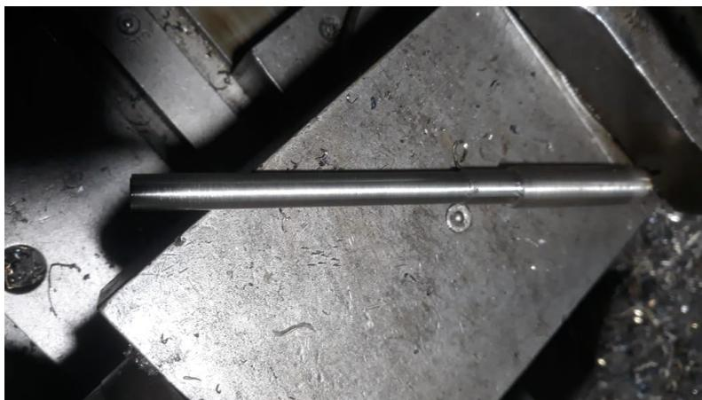
Par ensamblar los piñones a los ejes del sistema de transmisión y al eje del motor se utilizó acoples, los cuales fueron elaborados en acero AISI 1020 y para su construcción se manejó procesos de corte, torneado y taladrado (Figura 86).
