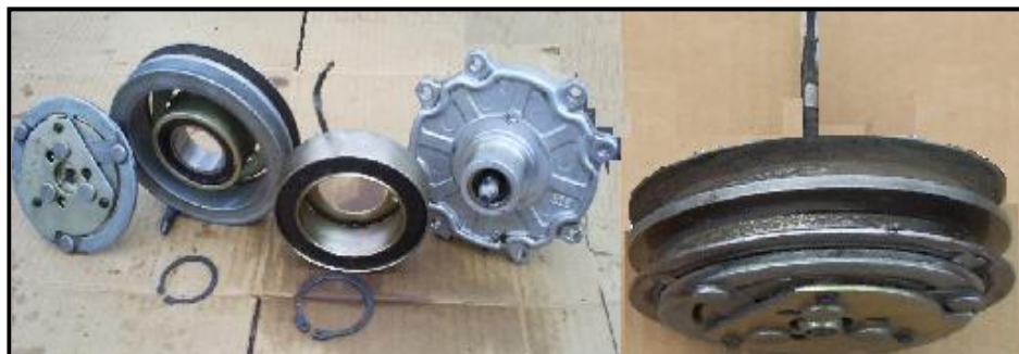
Fig. 3.12.- Embrague magnético (forma exterior)
