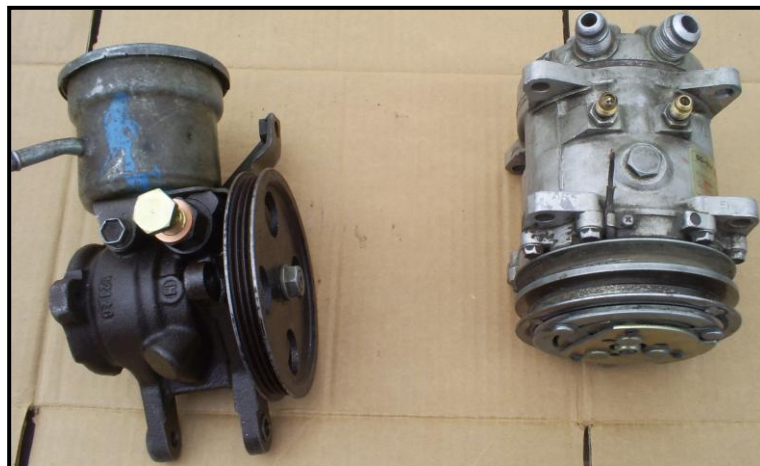
Fig. 4.1.- Esquema de una bomba hidráulica y un compresor de aire acondicionado
