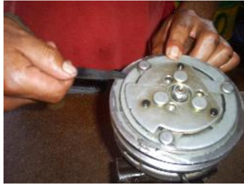
Fig. 4.20.- Calibración del embrague magnético
