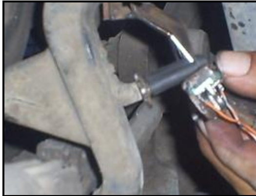
Fig. 4.29.- Montaje de la horquilla para el sensor de ángulo
