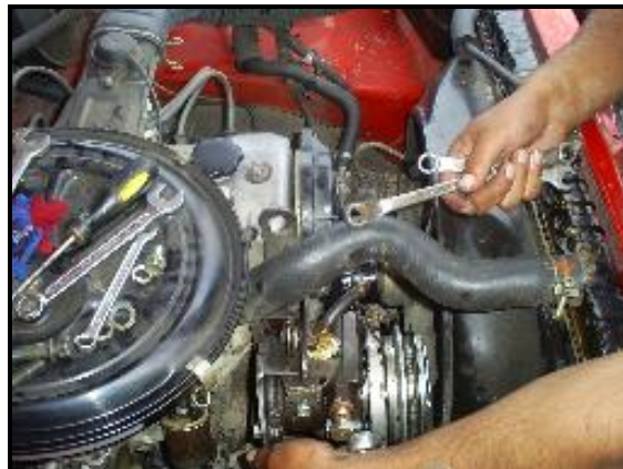
Fig. 4.24.- Montaje de l conjunto bomba – embrague
