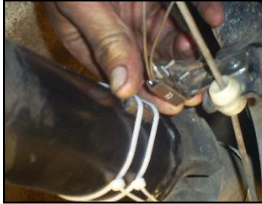
Fig. 4.26.- Alineación de los contactos del sensor
