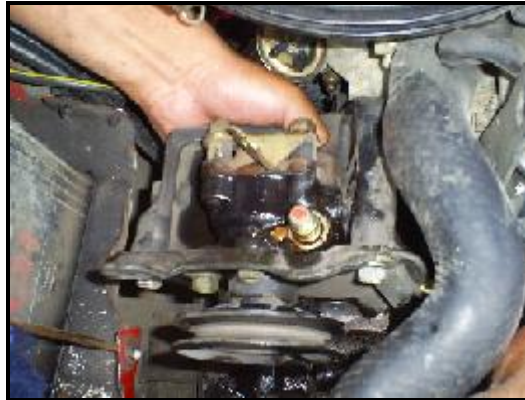
Fig. 4.21.- Desmontaje de bomba hidráulica anterior
