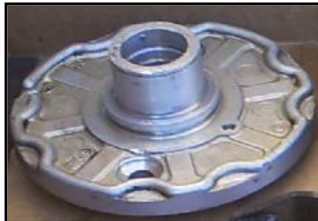
Fig. 4.10.- Eje de la polea del embrague culminada
