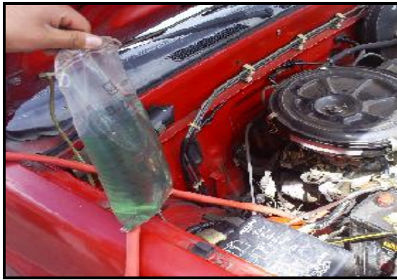
Fig. 5.6.- Succión de combustible desde nuestro depósito de medida
