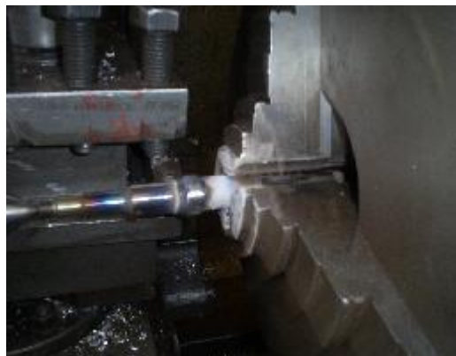
Fig. 4.5.- Rectificación del eje
