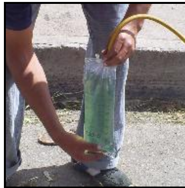
Fig. 5.9.- Llenado de combustible en el envase de prueba
