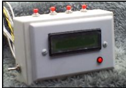
Fig. 4.35.- Control electrónico armado en la caja
