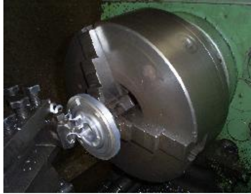
Fig. 4.9.- Mecanizado del eje de polea
