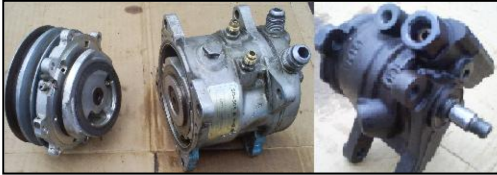
Fig. 4.2.- Bomba y compresor desarmado
