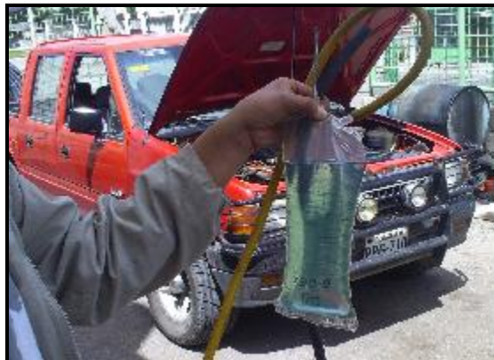
Fig. 5.5.- Llenado de combustible en el envase de prueba
