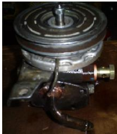
Fig. 4.19.- Montaje de la polea de embrague
