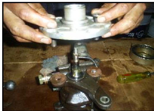
Fig. 4.17.- Montaje del eje de polea con el asiento de embrague
