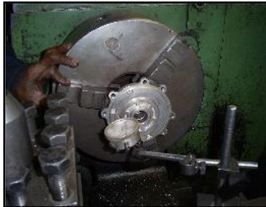
Fig. 4.8.- Centrado del elemento antes de mecanizar
