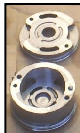
Fig. 4.15.- Cámara de alta presión de la bomba
