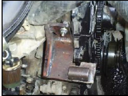
Fig. 4.23.- Montaje de la base de la bomba hidráulica
