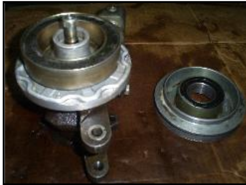
Fig. 4.18.- Montaje de la bobina inductora
