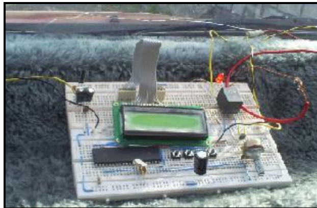
Fig. 5.11.- Montaje del control electrónico (en protoboar)
