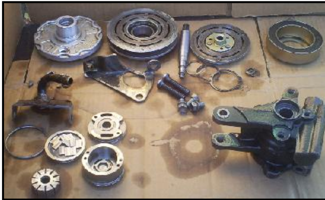
Fig. 4.14.- Componentes del conjunto bomba – embrague
