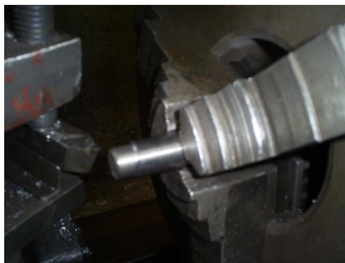
Fig. 4.3.- Corte del eje en el torno
