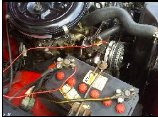
Fig. 5.13.- Conexiones de corriente al embrague de la bomba
