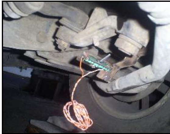
Fig. 4.28.- Montaje del sensor de ángulo en el vehículo
