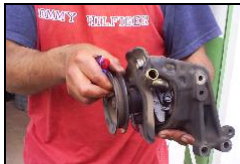
Fig. 4.22.- Extracción de la bomba hidráulica
