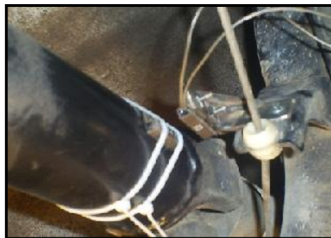
Fig. 4.25.- Montaje del sensor de velocidad
