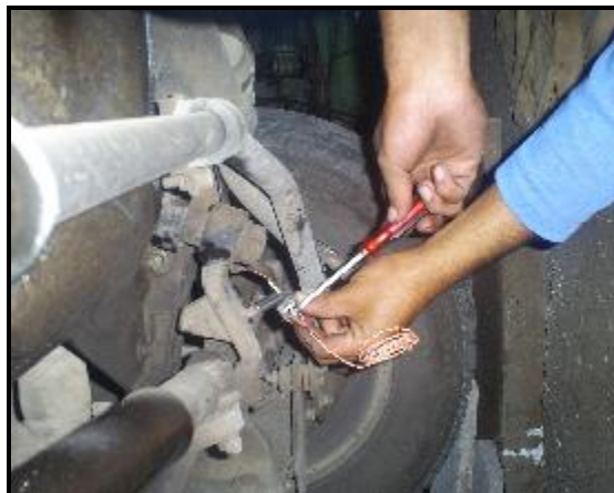
Fig. 4.30.- Conexiones del sensor de ángulo de dirección
