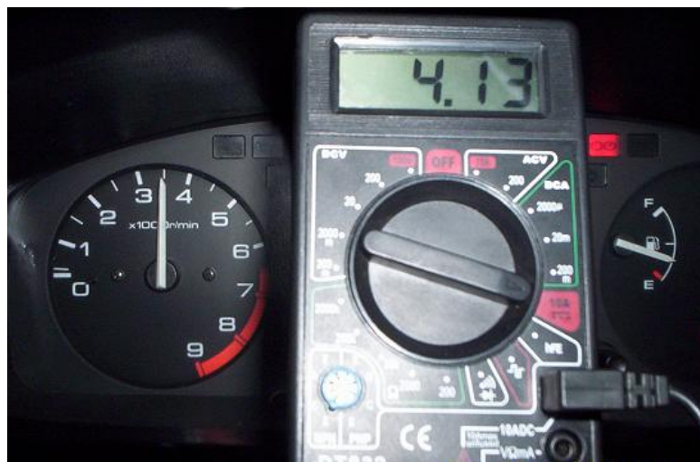
Figura 2.21 Medición de la corriente entre la llave de contacto y el módulo
