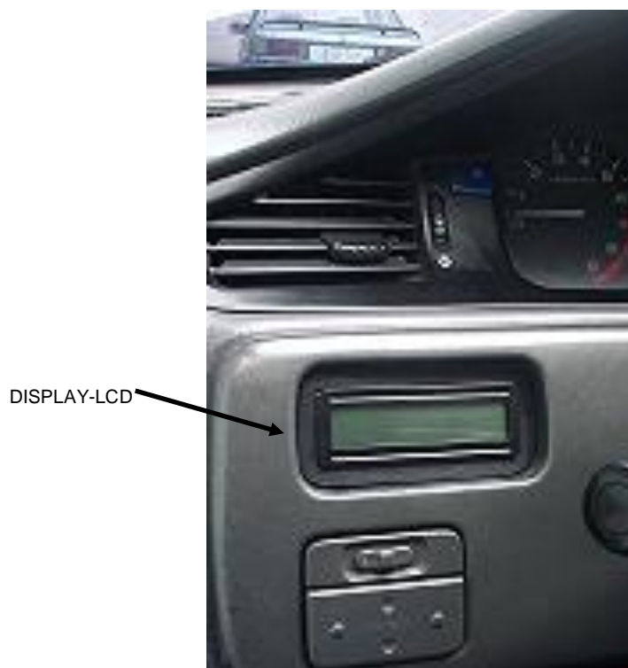
Figura 3.31 LCD instalado en el tablero
