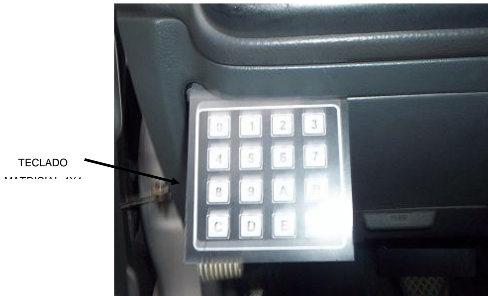
Figura 3.32 Teclado externo para desbloqueo al sistema de encendido
