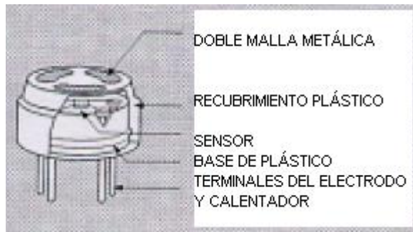
Figura 2.9 Encapsulado del sensor FIS SP
