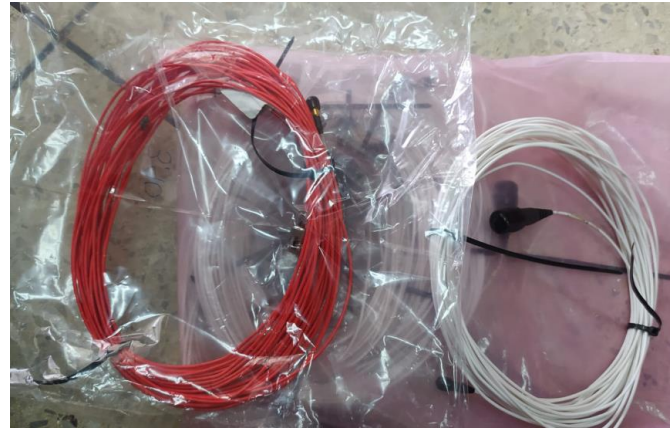
Cable coaxial, conexión BNC, 50 Ohm, conexión sensor a DAQ
