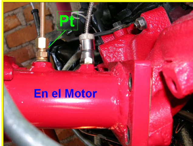
Figura 3.20. Fotografía de (Pt) montado en el sistema
