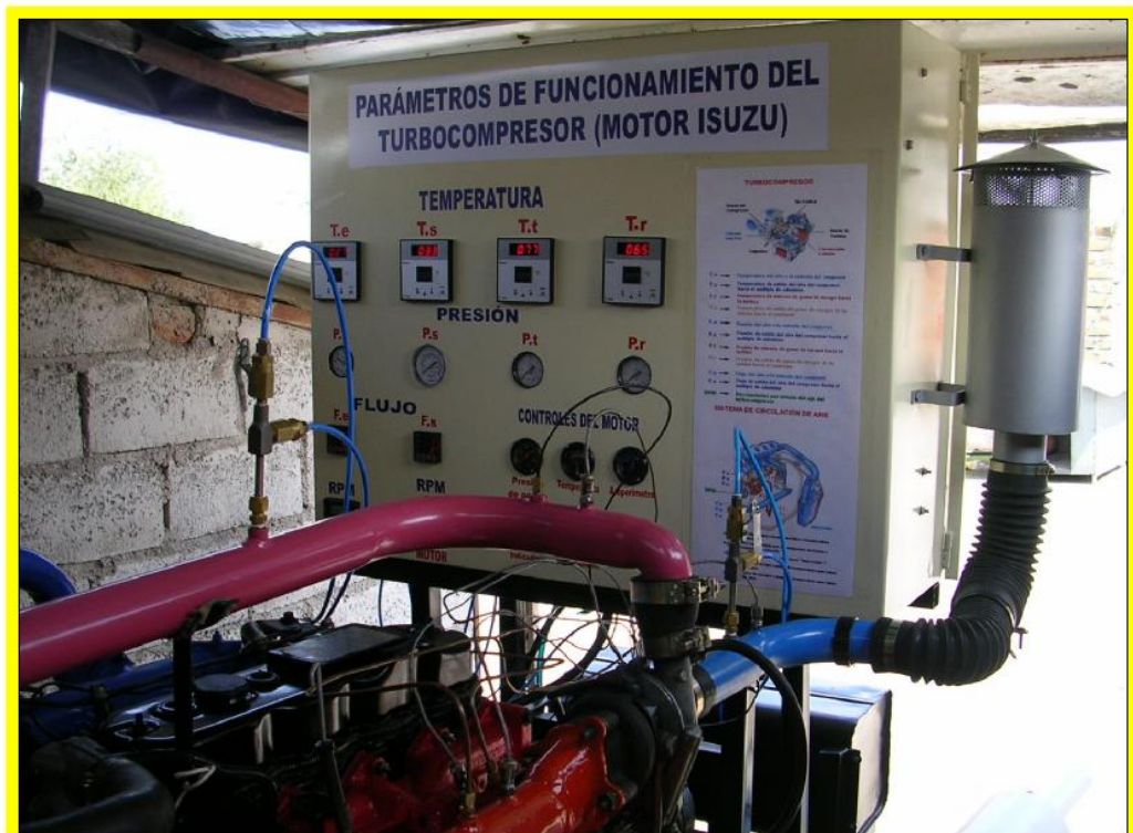
Figura 3.61. Fotografía del montaje terminado del tablero y los sensores
