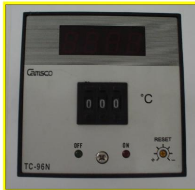
Figura 4.13. Control de temperatura
