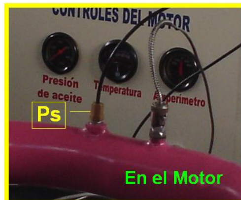
Figura 3.15. Fotografía de (Ps) montado en el sistema
