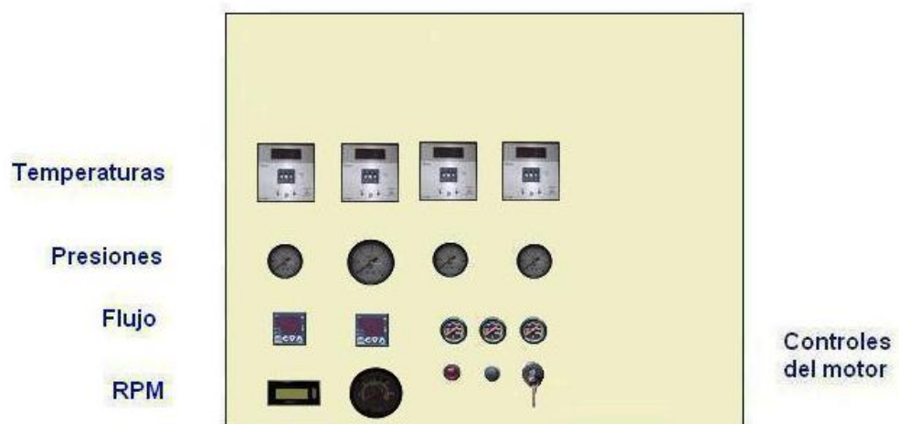
Figura 3.59. Tablero pintado y con los elementos que lo conforman
