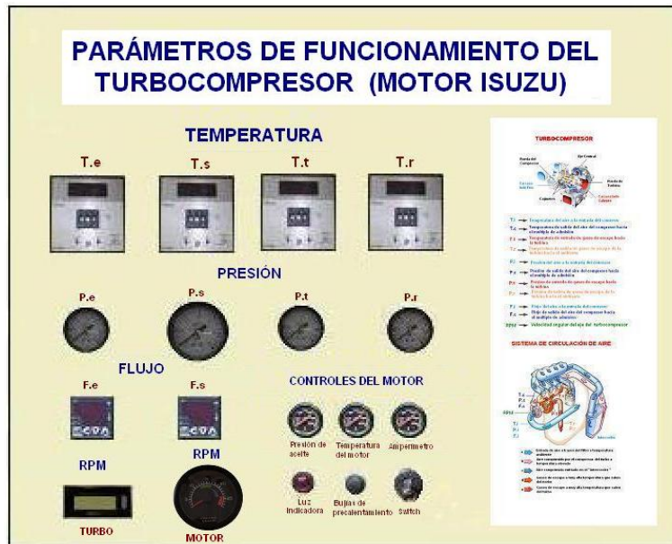
Figura 3.60. Rotulación de cada uno de los controles en el tablero
