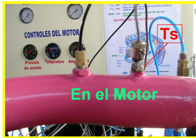
Figura 3.36. Fotografía de (Ts) montado en el sistema
