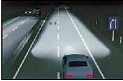
Figura 3.10. Generación del giro de los faros en recta
