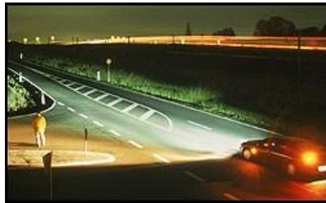
Figura 3.9. Generación del giro del faro en curva.
