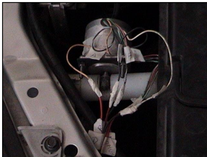
Figura 4.6. Montaje del motor p-p en la cremallera
