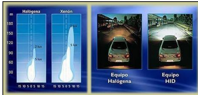
Figura 1.15 Alcance del haz de luz de una lámpara de gas o luz xenón
