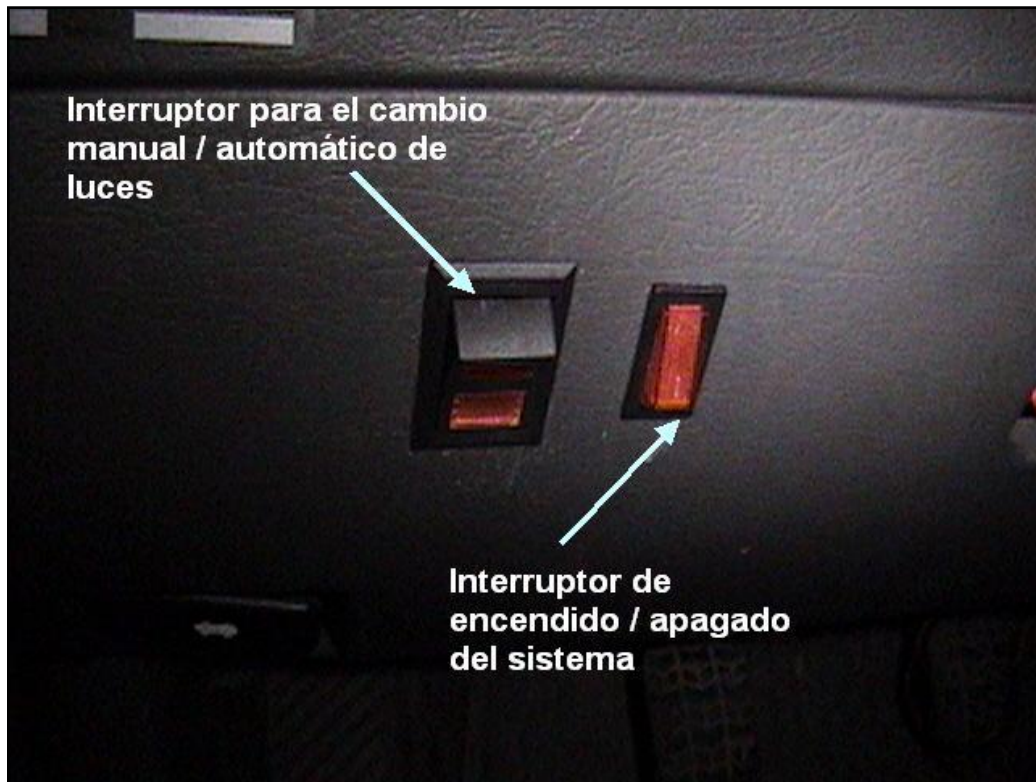
Figura 4.17. Interruptor de cambio automático / manual del cambio de luces
