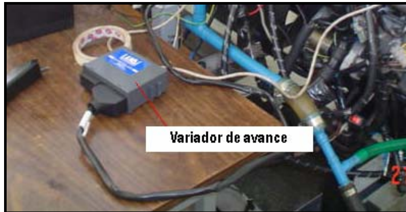
Figura 3.31 Conexión del variador de Avance
