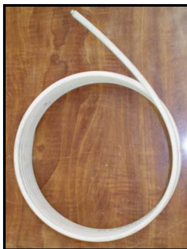
Figura 3.11 Tubería de alta presión
