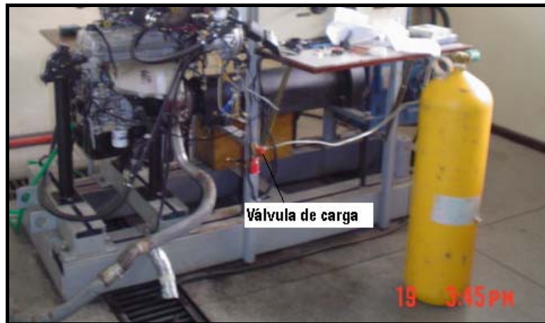
Figura 3.22 Posición de la válvula de carga en el banco de pruebas
