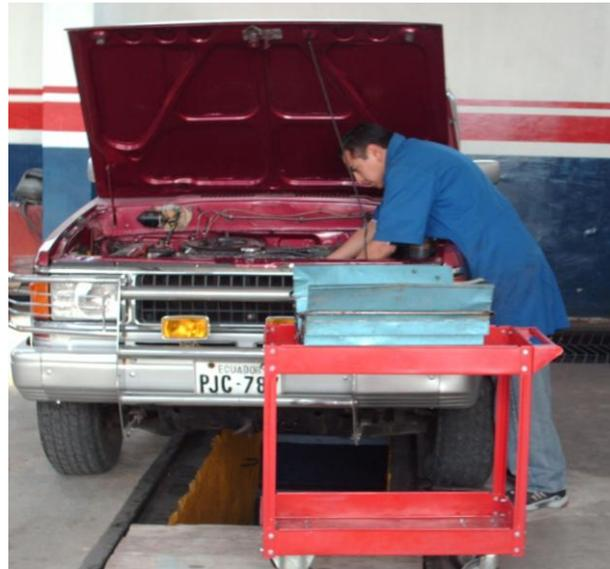
Figura 3.5. Cambio de banda del alternador
