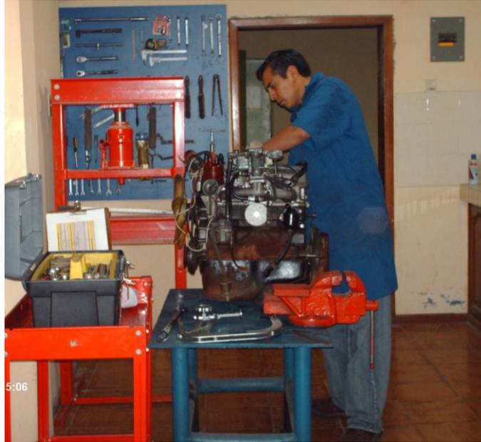
**Figura 3.13 Reparación de un motor de cuatro cilindros**
