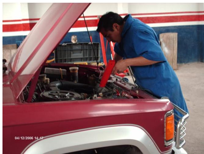
Figura 3.6. Comprobación del encendido
