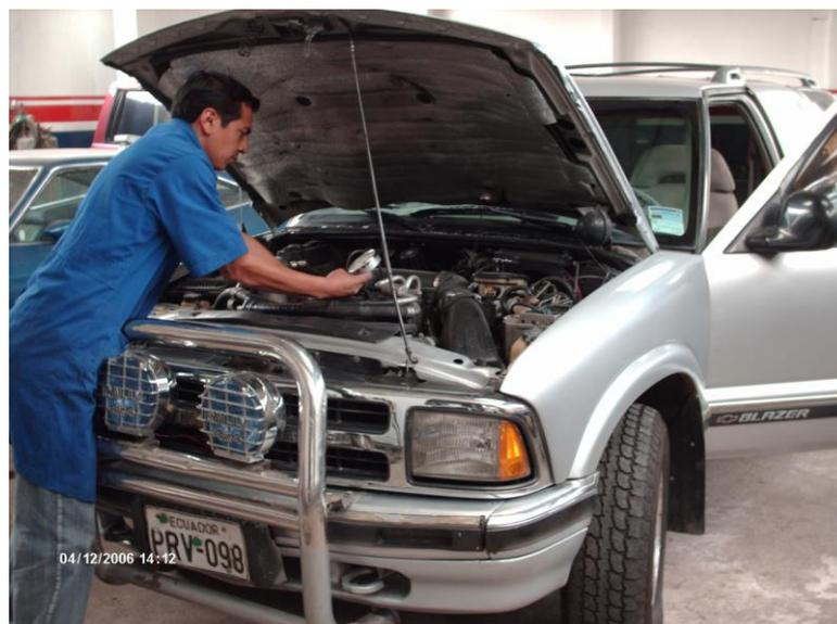
Figura 3.4. Chequeo del vacío del motor
