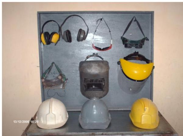
**Figura 6.9 Equipo de seguridad**
