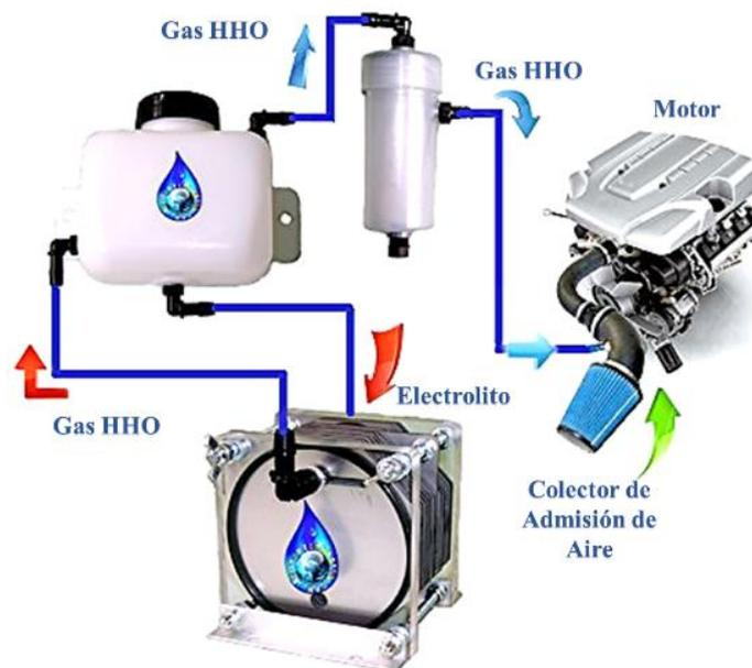
*Nota.* En la imagen se observa cómo se genera HHO y su circulación a través de los componentes del kit hasta llegar al motor. Tomado de (ABSOLUTENERGIES, 2016).
