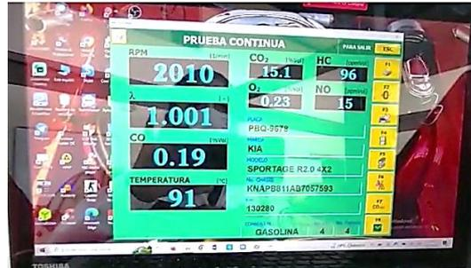
*Nota:* En la imagen se observa la adquisición de datos de la prueba continua – 2000 RPM
