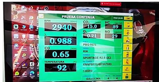
*Nota.* En la imagen se observa la adquisición de datos de la prueba continua – 3000 RPM
