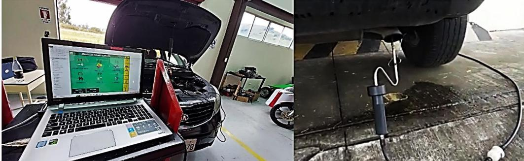
*Nota:* En la imagen se observa la interfaz del software del analizador de gases (izq.) y la colocación de la sonda de medición (der.) como parte de la ejecución del protocolo de uso del analizador de gases.
