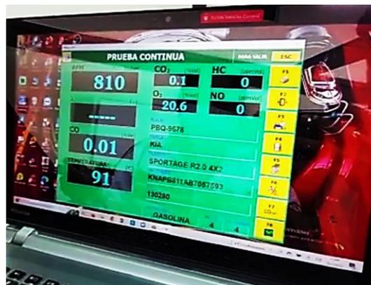
*Nota.* En la imagen se observa las mediciones de las emisiones del MEC en la prueba continua – ralentí.
