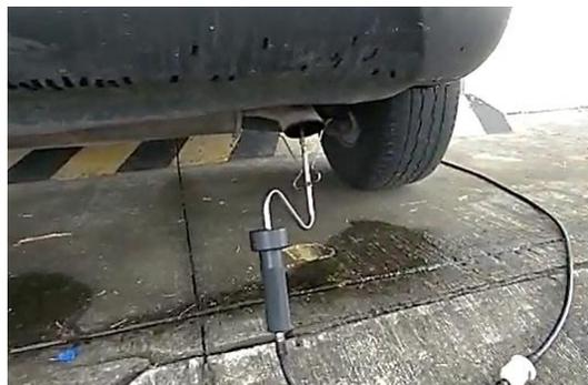
*Nota.* En la imagen se observa la ubicación de la sonda de medición para la prueba continua.
