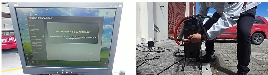
*Nota.* En la imagen se observa la interfaz del opacímetro (izq.) y comprobación del funcionamiento (der.) del equipo.
