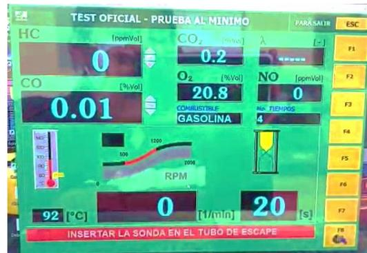
*Nota.* En la imagen se observa la interfaz del software del equipo cuando este se encuentra listo para el test oficial – prueba al mínimo.
