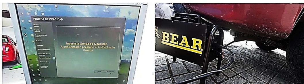
*Nota.* En la imagen se observa la interfaz para iniciar la prueba (izq.) y la ubicación de la sonda para la medición de opacidad (der.) en el vehículo de prueba.
