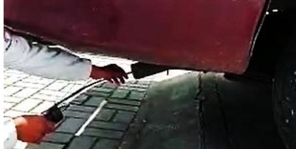
*Nota.* En la imagen se observa cómo se debe sostener la sonda de medición en la salida del escape para retirarla rápidamente.
