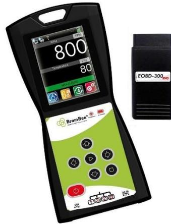
*Nota.* En la imagen se observa el equipo para medir RPM utilizado en la investigación.
