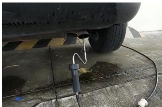
*Nota.* En la imagen se observa la ubicación de la sonda de medición en la salida del escape
