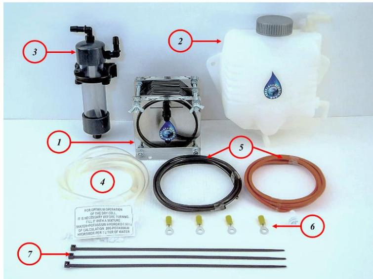
*Nota.* En la imagen se observa los componentes del kit de generación de hidrógeno utilizado en la investigación. Tomado de (ABSOLUTENERGIES, 2016).
