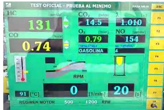
*Nota.* En la imagen se observa la interfaz del software del equipo cuando se realiza la medición de emisiones en ralentí.
