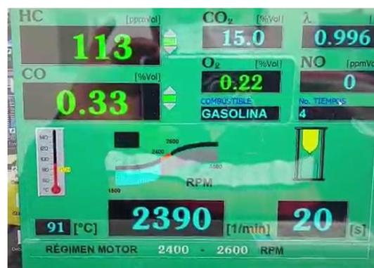
*Nota.* En la imagen se observa la interfaz del software del equipo cuando se realiza la medición de emisiones a 2500 RPM
