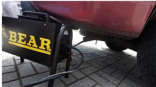
*Nota.* En la imagen se observa la forma correcta de ubicar la sonda de medición de opacidad en el vehículo de prueba.
