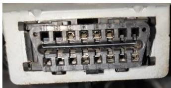
*Nota.* En la figura se puede observar el conector OBD-II de 16 pines el cual se encuentra ubicado en la parte inferior de la columna de dirección del vehículo.
