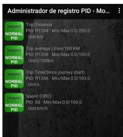
*Nota.* En la figura se evidencia los 4 PID a ser utilizados en las pruebas de consumo tanto para gasolina como diésel.
