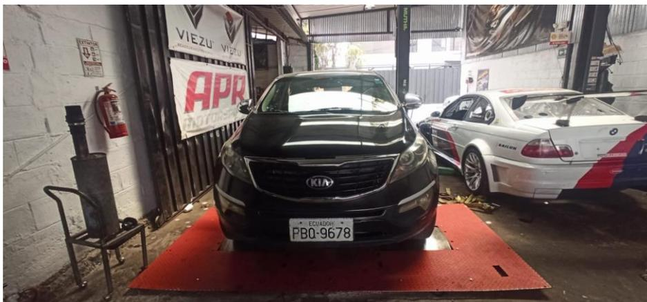
*Nota.* En la figura se muestra el posicionamiento y montaje del vehículo sobre los rodillos del dinamómetro.
