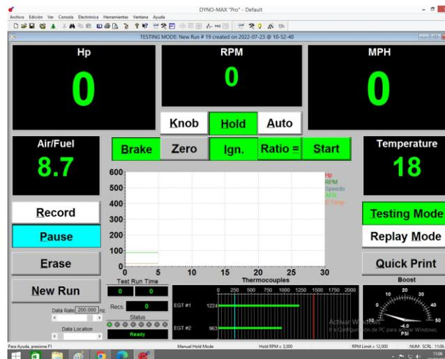
*Nota.* La figura indica la pantalla principal del software para el registro de datos de torque y potencia
