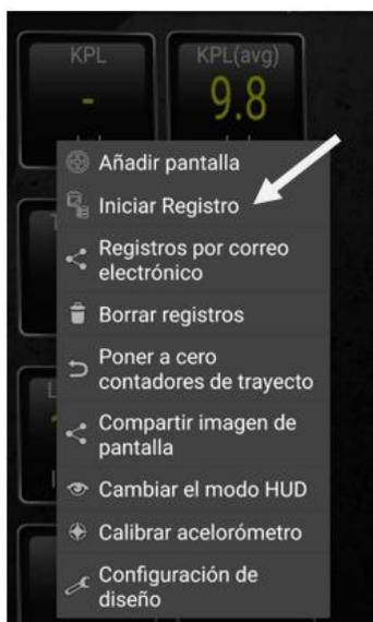
*Nota.* En la figura se muestra el entorno de la aplicación en la sección de información en tiempo real, donde se encuentra la opción que permitirá grabar los PID seleccionados para luego poder analizarlos.
