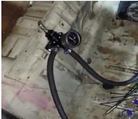
Permite un ajuste de presión de 28.45 PSI a 113.8 PSI.
