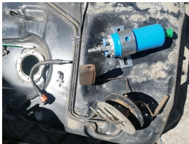
Desmontaje de componentes del tanque
