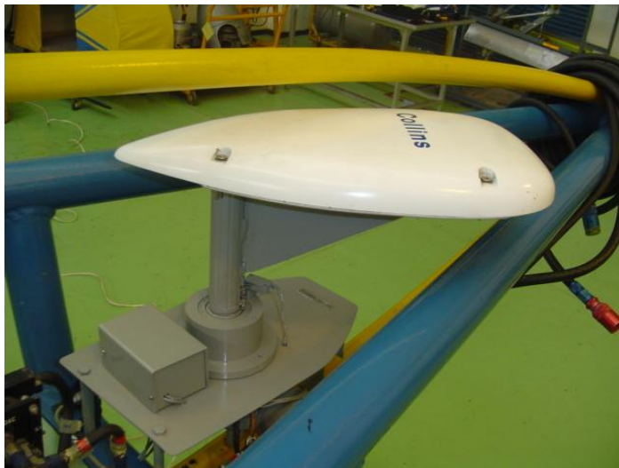
Fig. 4.8 Rotor de antena implementado
