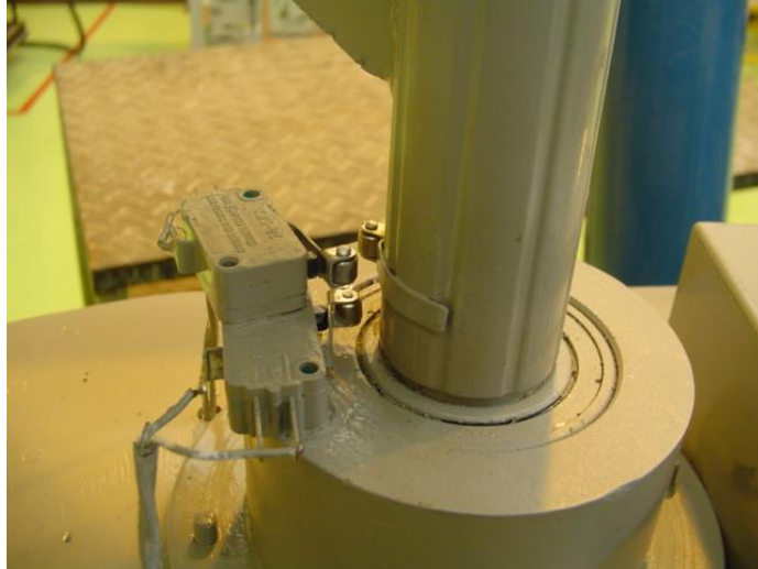
Fig. 4.7 Finales de carrera normalmente cerrados en el rotor de antena
