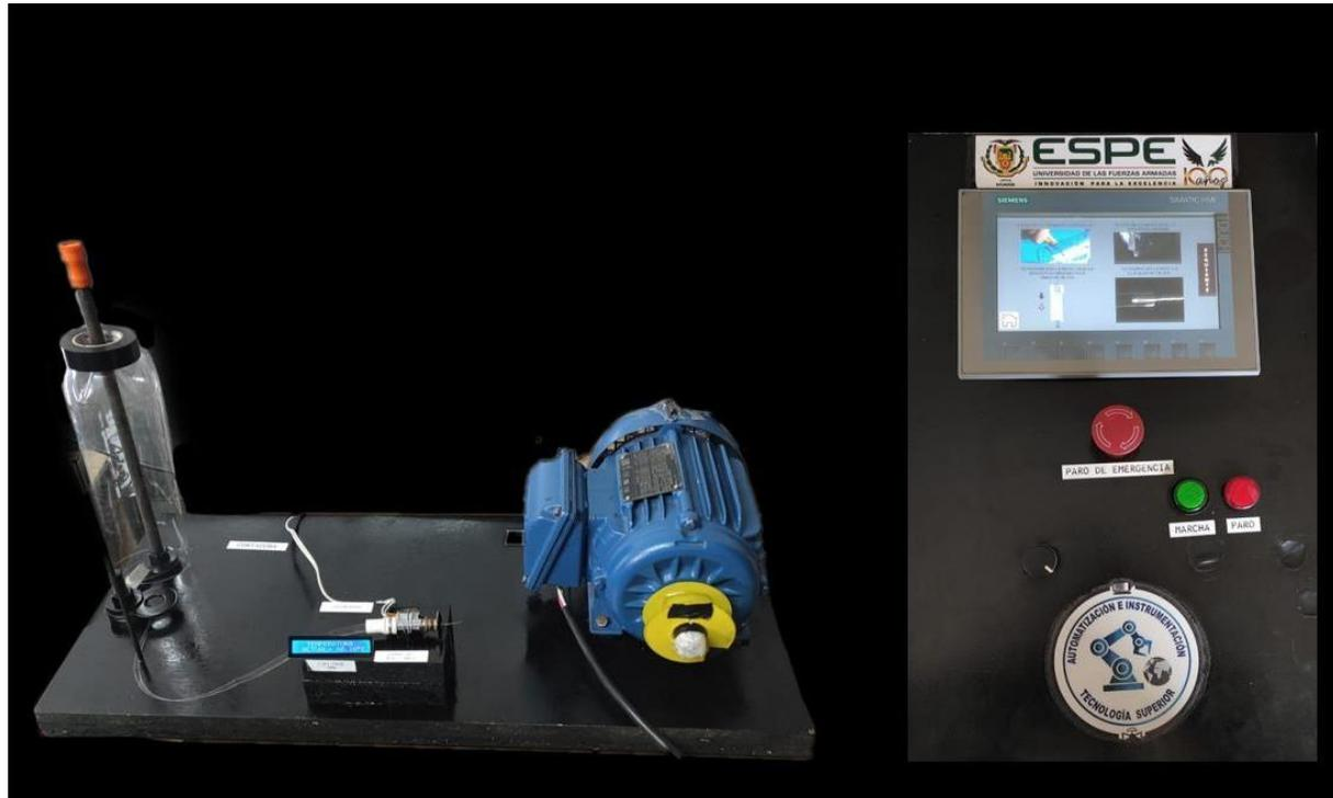
Extrusora de filamento PET, tablero de control con una pantalla KTP900
