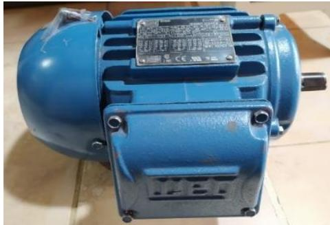
*Nota.* En la figura se muestra un motor eléctrico WEG W22 de 3HP trifásico 1800RPM.
