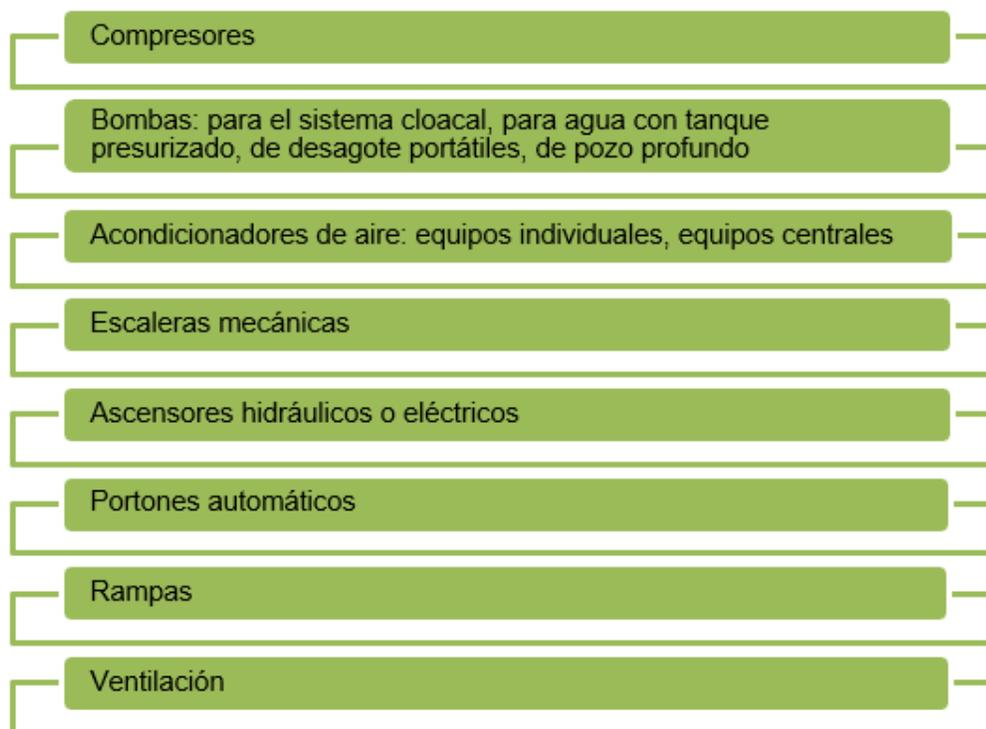
*Nota.* En la figura se muestra los dispositivos y aplicaciones de motores trifásicos. Tomado de (Farina, 2018)
