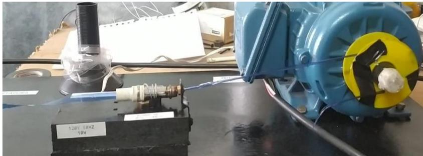
*Nota.* En la figura se muestra el funcionamiento de la calentadora dando como resultado el filamento PET. (Figuroa, 2022).
