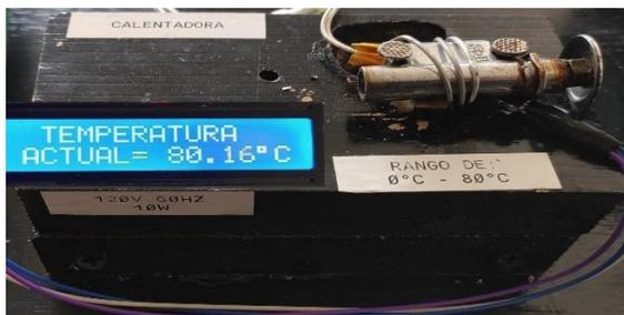
*Nota.* En la figura se muestra la visualización de la temperatura alcanzada por la calentadora para la obtención del filamento PET.
