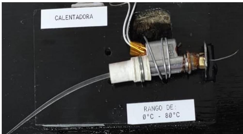
*Nota.* En la figura se muestra la estación de la calentadora con las especificaciones descritas.
