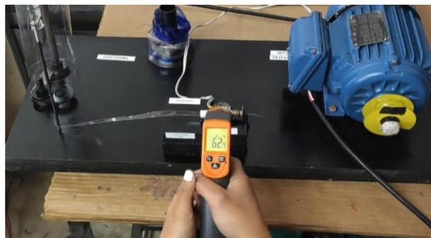
*Nota.* En la figura se muestra la temperatura de la calentadora para la obtención del filamento PET.
