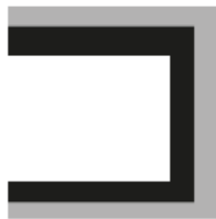
Refuerzo interior en U
