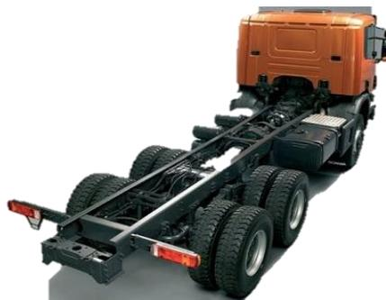
*Nota.* En la figura se aprecia el bastidor de camión con perfil en U. Tomado de. Carrocería y pintura.
