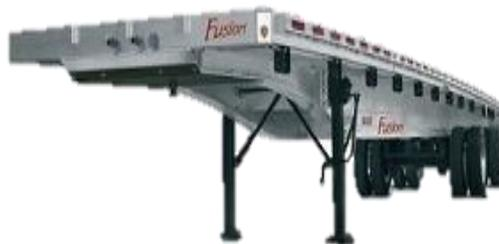
*Nota.* En la figura se aprecia el bastidor en doble T el cual se utiliza en la fabricación de semirremolques. Tomado de. Conocer los camiones
