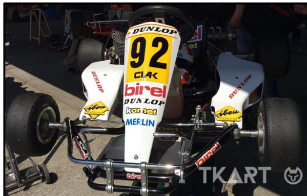
*Nota.* La figura muestra al carenado de un kart en fibra de vidrio. Tomada de: (TKart, 2019)
