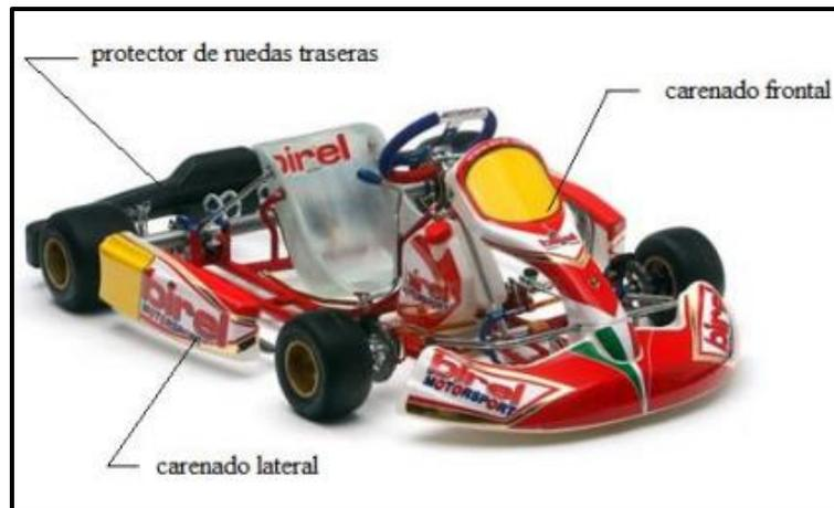
*Nota.* La figura muestra las partes del carenado del kart. Tomada de: (Aguado, 2014)
