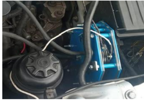
Instalación del reactor
