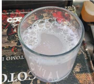
*Nota.* En la imagen se observa un método de retención temporal del hidrógeno, mediante la solución jabonosa.
