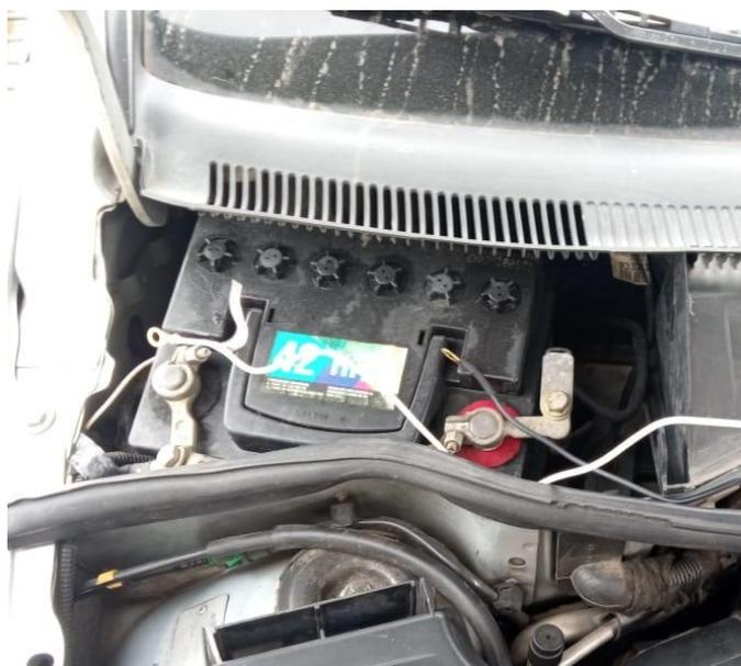
*Nota.* Conexión eléctrica final del generador de hidrógeno a la batería.
