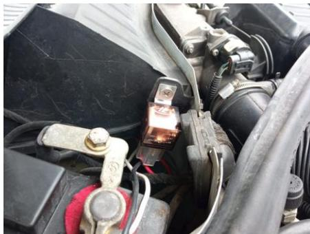
*Nota.* El relevador está sujeto a una base rígida del compartimento del motor.
