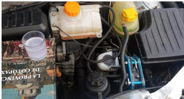
*Nota.* En la figura se observa el reactor instalado en el compartimento del motor.
