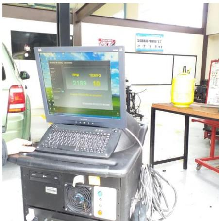
*Nota.* En la figura se observa el equipo analizador de gases contaminantes de la marca CARTEK.
