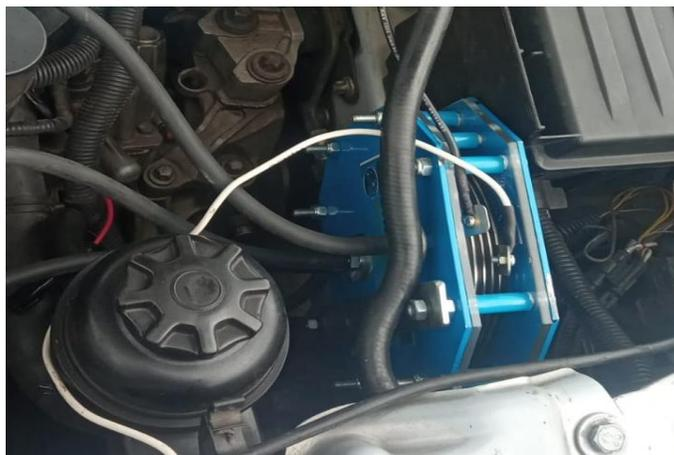
*Nota.* El reactor es el equipo de color azul instalado entre la caja de fusibles y depósito de aceite de dirección.
