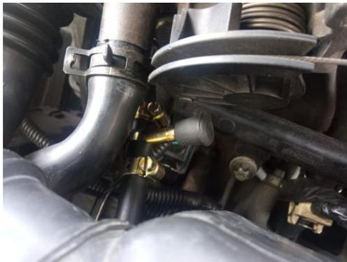
*Nota.* La figura indica la toma de vacío con el acople en T.
