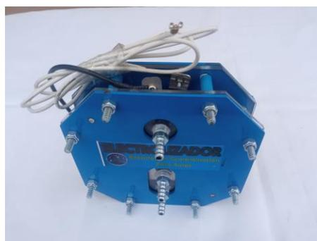
*Nota.* Bornes del reactor, cable negro a tierra y blanco a positivo de la batería.
