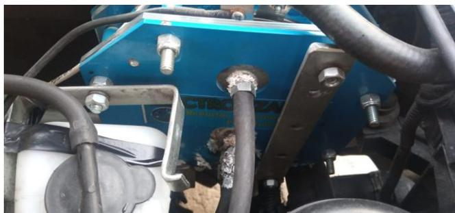
*Nota.* En esta figura se observa el ducto por donde sale las partículas de HHO, antes de la filtración.
