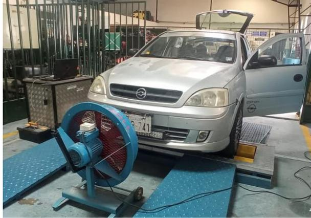
*Nota:* En la figura se observa al vehículo sobre los rodillos del dinamómetro de inercia.
