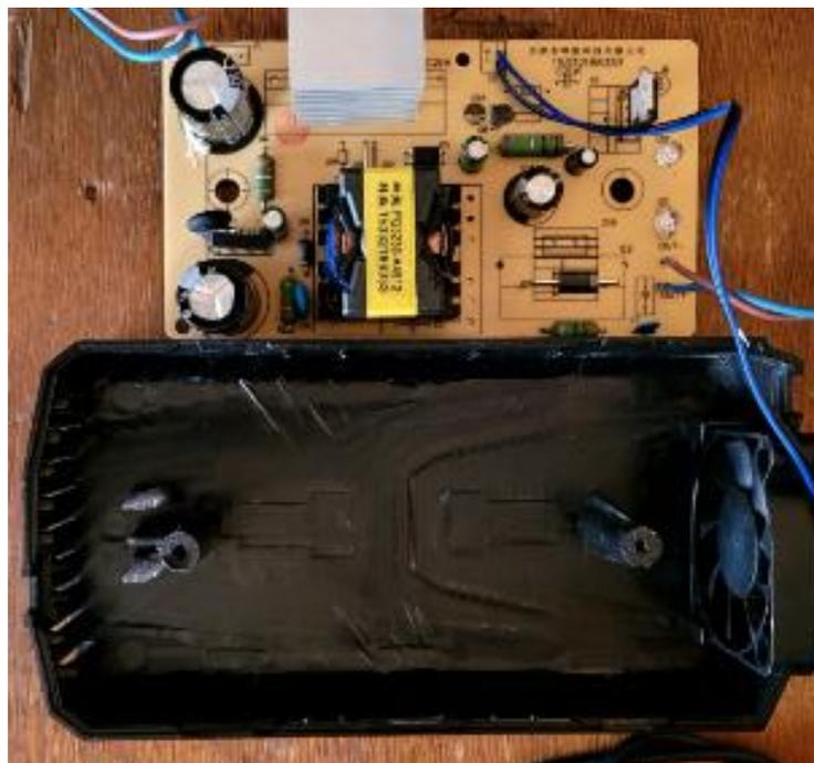
*Nota.* En la siguiente imagen se representa un cargador y sus componentes internos, la cual transforma los 110V a 59V para la recarga de las baterías de la moto Classic II.
