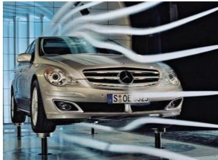
*Nota.* La figura indica las líneas del flujo de aire que chocan con la carrocería del vehículo.
