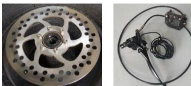
*Nota.* Sistema de freno de motocicleta (disco, bomba, pedal, manguera, pistones y pastillas)
