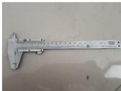
*Nota.* Se usó el pie de rey para medir espesores y anchos de tubos y perforaciones
