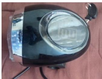
*Nota.* Indicador de nivel de carga de la batería
