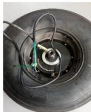
*Nota.* Motor eléctrico, ubicado en la llanta trasera
