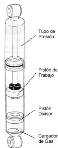
Figura 2.7 Diseño de Amortiguador Monotubo 8
