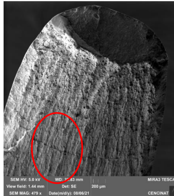
zona de grieta
