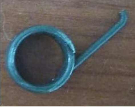
a) Resorte original fracturado
