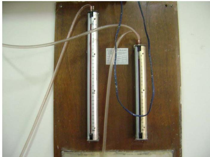
**Figura 2.15 Manómetros diferenciales**
