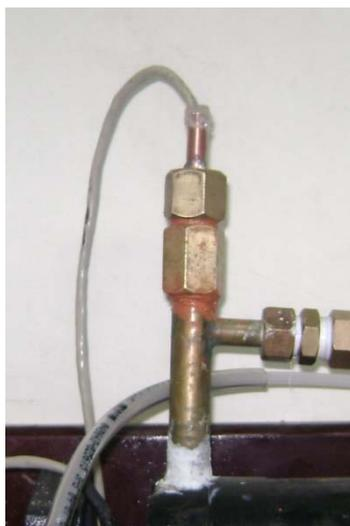
**Figura 6.9 Sensores de Temperatura al interior del capuchón de cobre**
