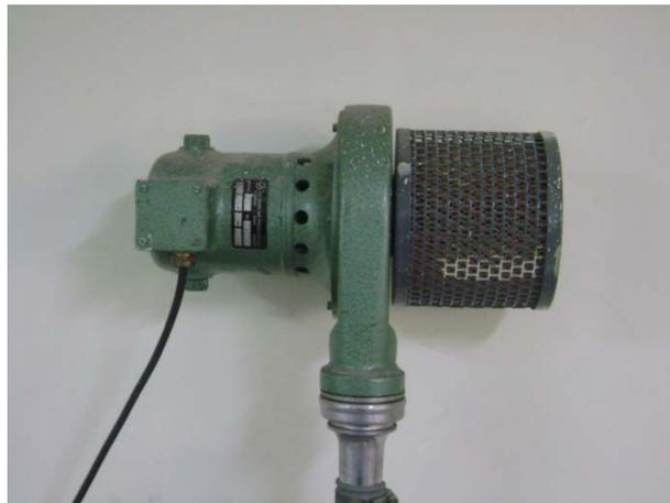
**Figura 2.9 Turbina de aire**
