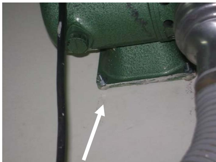
**Figura 6.4 Motor eléctrico y pernos de expansión**
