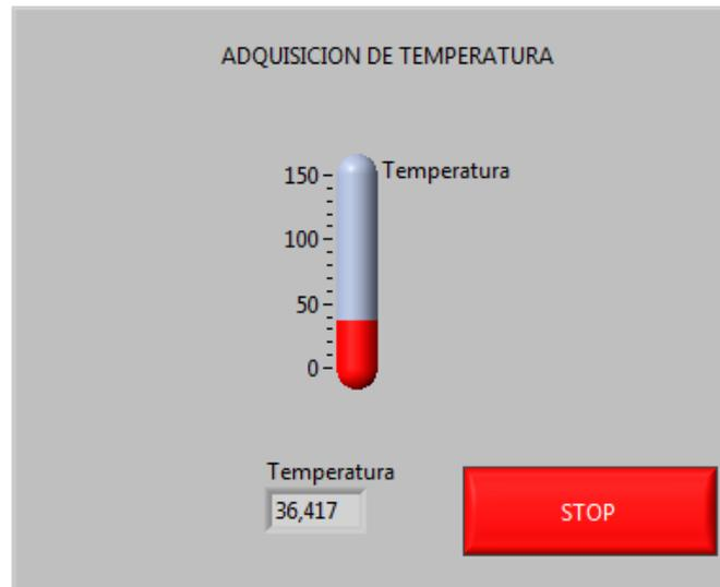
**Figura 5.10 Panel Frontal VI del sensor de la temperatura luego de toma de datos**
