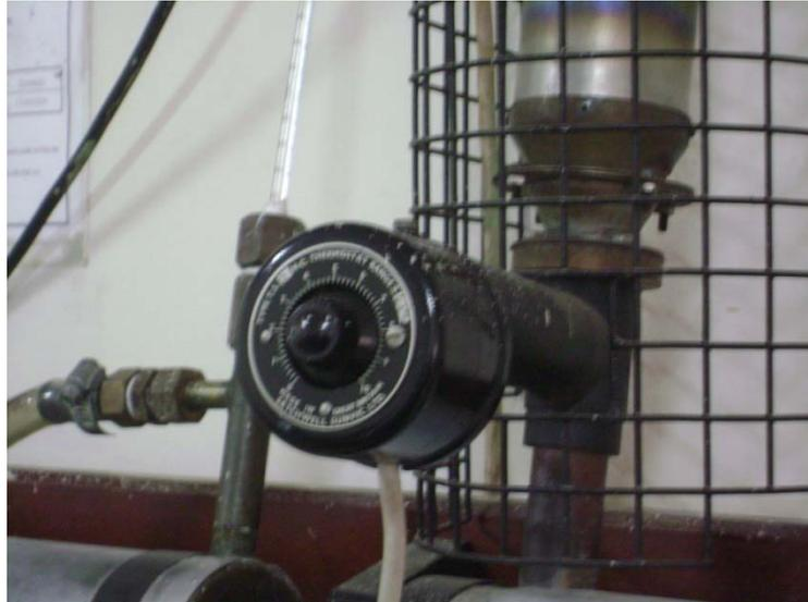
**Figura 2.10 Termostato eléctrico**
