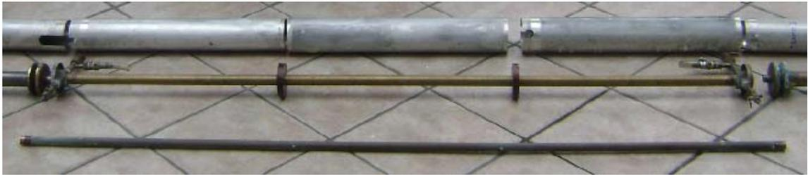
**Figura 2.8 Tubos concéntricos del intercambiador de calor**
