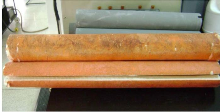
**Figura 3.9 Cañuelas nuevas para sustitución**
