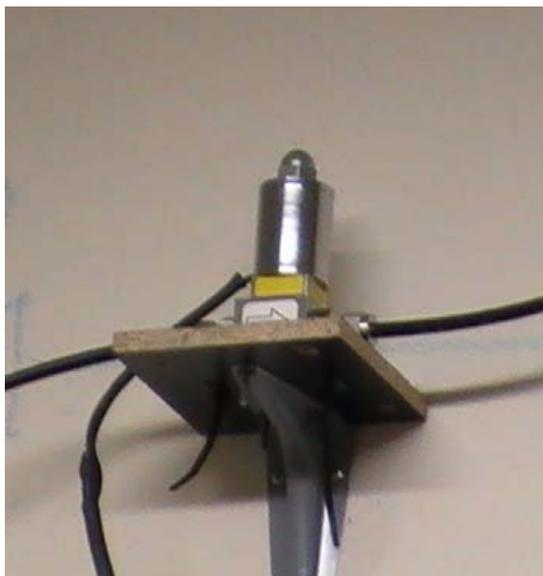
**Figura 6.14 Válvula Proporcional en posición vertical**
