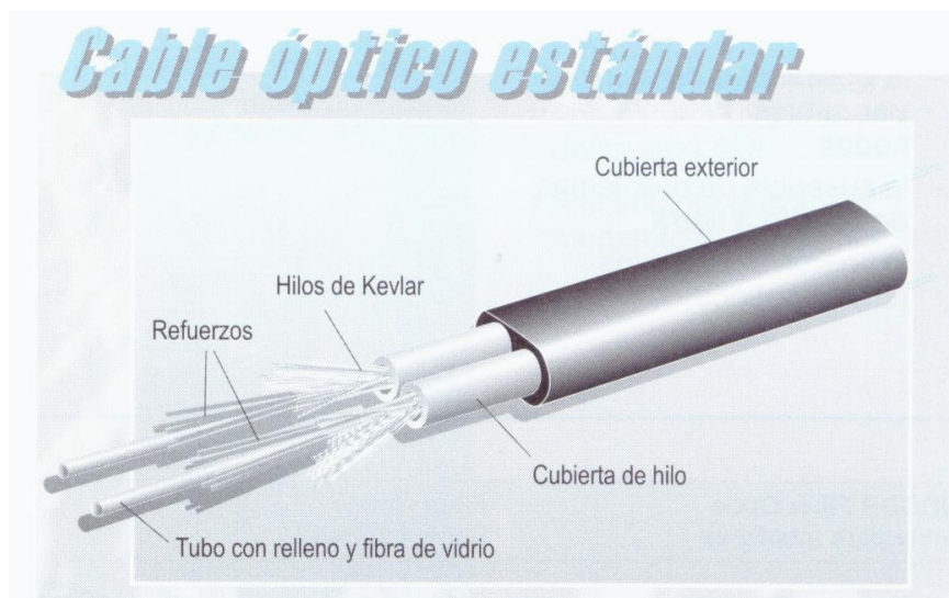
Figura 1.25 Fibra óptica de vidrio estándar para aplicaciones industriales.
