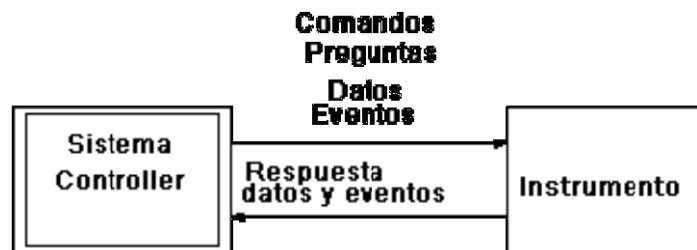
Figura 2.5 Flujo de información con el bus GPIB
