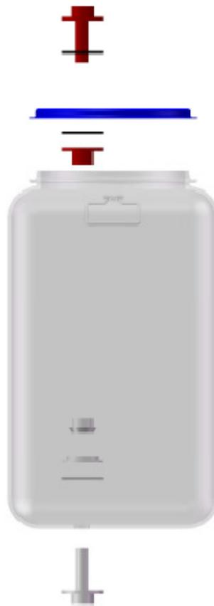
**Figura 5.10** Instalación de adaptadores en tanque superior
