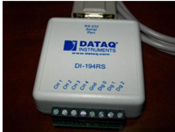
**Figura 4.10** Hardware de adquisición de datos seleccionado
