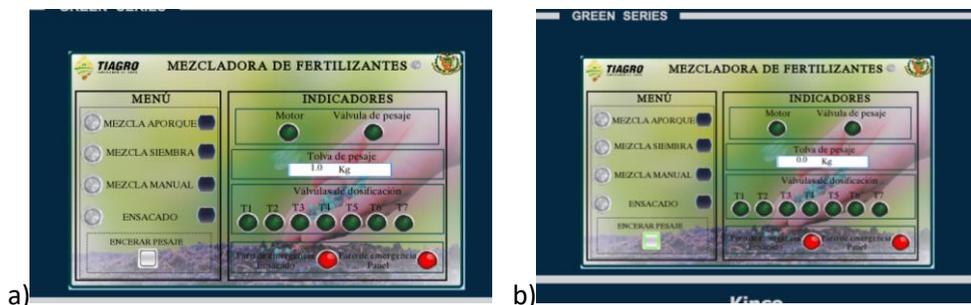
*Nota.* En la figura 72 se puede observar el menú principal y además el encerado del pesaje en donde en a) el pesaje está movido y en b) el pesaje encerado después de presionar el botón
