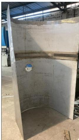
Posteriormente se procedió al corte mediante láser de los laterales de la tolva de mezclado, para luego ser soldados como se indica en la figura 56
