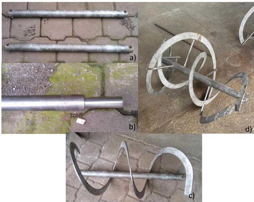
*Nota.* En la figura el literal a muestra los tubos donde se soldarán las hélices de la tolva de mezclado, el literal b muestra el maquinado del eje de la mezcladora y el literal c y d muestran el armado de las hélices de la mezcladora.
