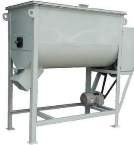
*Nota.* La figura muestra una mezcladora horizontal la cual está formada por una parte rectangular y una forma circular. Tomado de (Molinos Azteca, 2015)
