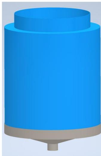
Se han diseñado dos embudos uno para tanques pequeños con capacidad de 5 quintales (250kg) y otro para tanques grande con capacidad de 10 quintales (500kg) se lo ha diseñado en acero inoxidable 304 y se comprobó su resistencia mediante software como se muestra en la figura 43. Para conocer las medidas de los embudos y los tanques revisar Anexo A.
