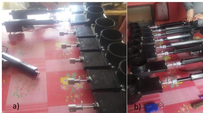
*Nota.* El literal a de la figura muestra la colocación del acople y los finales de carreta, el literal b muestra el ensamble completo de actuadores y válvulas.
