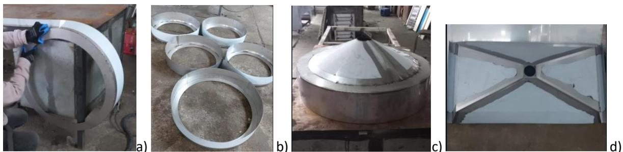
*Nota.* El literal a y b indican el corte y doblado de las láminas para los embudos de las tolvas de almacenamiento y el literal c y d muestran el resultado luego de la soldadura de los embudos y la tolva del pesaje respectivamente
