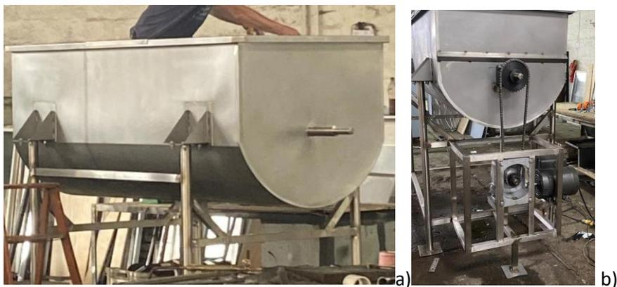
*Nota.* En el literal a se observa la colocación del eje en la mezcladora, mientras que en la figura b se puede observar todo el sistema de movimiento del eje conectado.
