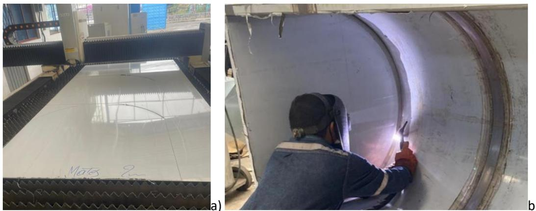
*Nota.* La figura muestra en el literal a el corte de las láminas para los laterales de la tolva de mezclado y en el literal b la suelda de los mismos en la lámina previamente doblada
