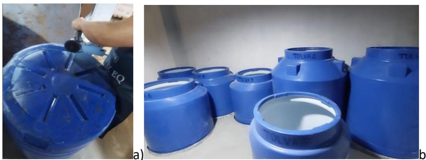
*Nota.* El inciso a muestra el corte de la base de los tanques plastigama, mientras que en el inciso b se pueden observar todos los tanques de almacenamiento colocados en sus respectivos embudos.
