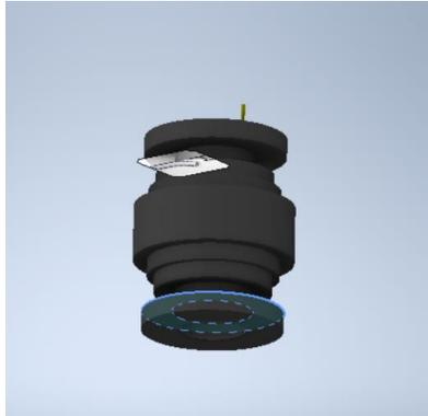
Se establece que el desplazamiento máximo es de 0.96mm por lo que es mínimo, y además se tiene un factor de seguridad de  $N=15$ , de esta forma cumple con un correcto diseño e integridad estructural como se muestra en la Figura 45.
