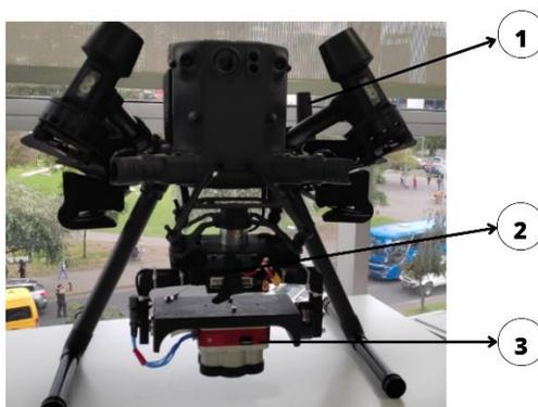
*Nota.* 1. Dron DJI M300 RTK, 2. Sistema estabilizador, 3. Sensor multiespectral Micasense Altum
