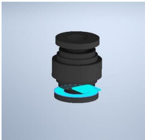
La carga total del sistema de amortiguación se divide para las 12 gomas de amortiguamiento, por lo que, se aplicó una carga de 2N como se muestra la Figura 44.
