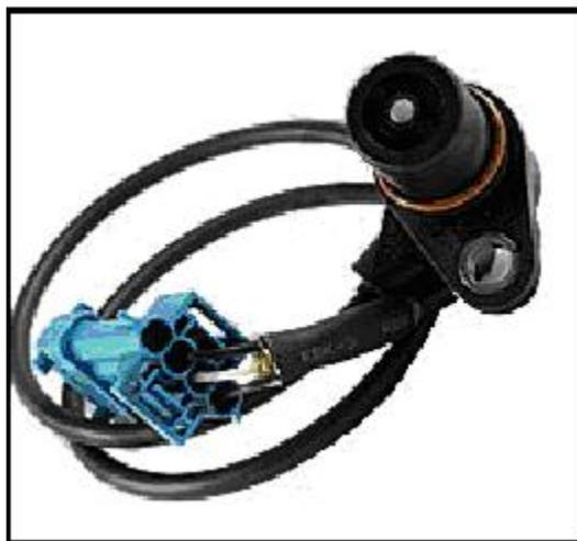
Figura 2.2 Sensor de posición del cigüeñal
