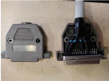
Aumentar el grosor del cable a cable flexible N°18 y realizar el aislamiento mediante termo contraíbles.
