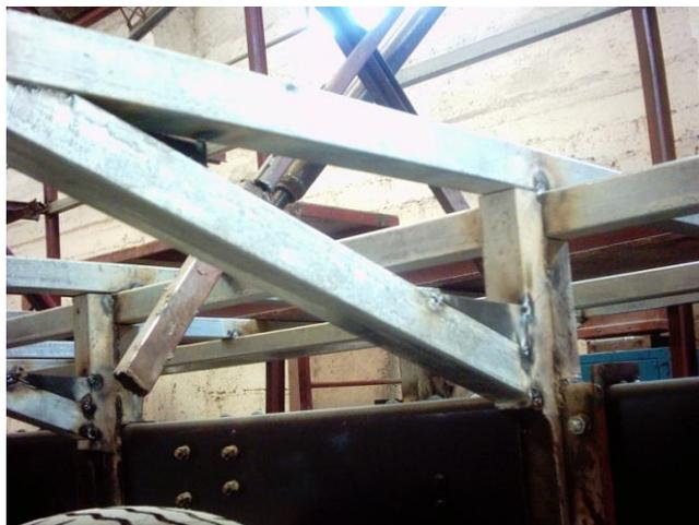
**Figura 3.3.- Estructura del piso**
