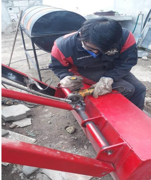
*Nota.* En la figura se puede verificar el desbaste de la base donde se montó el final de carrera, se llevó a cabo este proceso para evitar rozamiento con el cilindro o con las líneas hidráulicas del sistema hidráulico.
