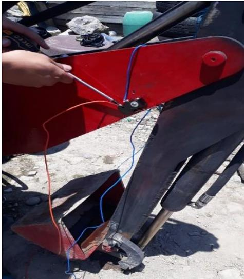
*Nota:* La fotografía muestra la conexión del cableado de los finales de cada uno de ellos este procedimiento se realiza a todos los finales de carrera que se colocaron en el banco de entrenamiento de maquinaria pesada.
