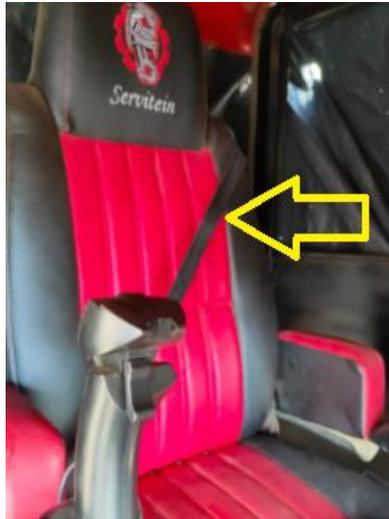
*Nota.* La fotografía muestra el acoplamiento del cinturón de seguridad al asiento del operador del banco de entrenamiento.
