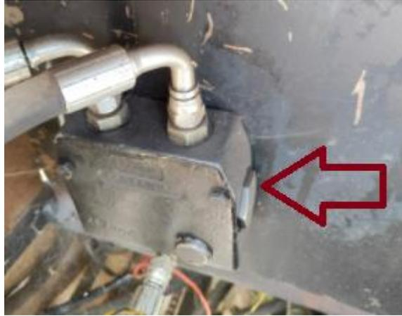
*Nota.* La fotografía indica el anclaje de la válvula reguladora de presión al compartimiento trasero donde se encuentra montado el motor de combustión interna.
