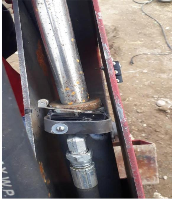
*Nota.* La fotografía muestra el final de carrera montado en el cilindro con un proceso de soldadura, para lograr mejor fijación.
