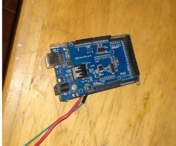
*Nota.* La fotografía indica la conexión al pin de reseteo al Arduino, con el fin de controlar el sistema electrónico como medio de seguridad controlada por pulsadores en cada Arduino se implementó el montaje de los pulsadores.
