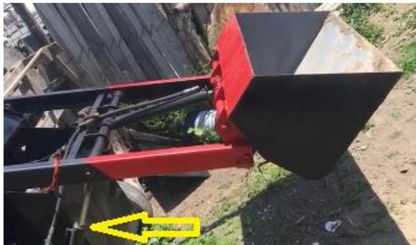
*Nota.* La fotografía señala el control de los finales de carrera en los brazos de la pala mecánica del banco de entrenamiento de maquinaria pesada.
