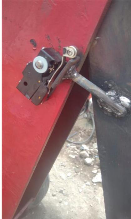
*Nota.* La fotografía evidencia el accionamiento de la pluma con el interruptor del banco de entrenamiento de maquinaria pesada con el fin de tener contacto con el final de carrera y poder retener de una manera suave o tranquila al momento del accionamiento de la misma.
