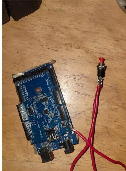
*Nota.* La fotografía enseña el pulsador de seguridad del sistema hidráulico con el cual se controla la electrónica e hidráulica a la vez actúa como medio de control y de seguridad.
