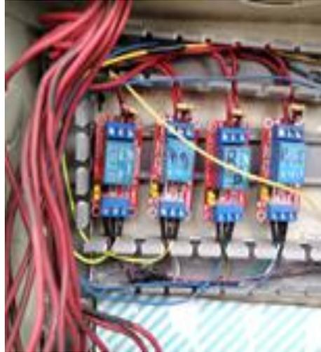
*Nota.* La fotografía expone el funcionamiento de los relés de tracción del banco de entrenamiento de maquinaria pesada.
