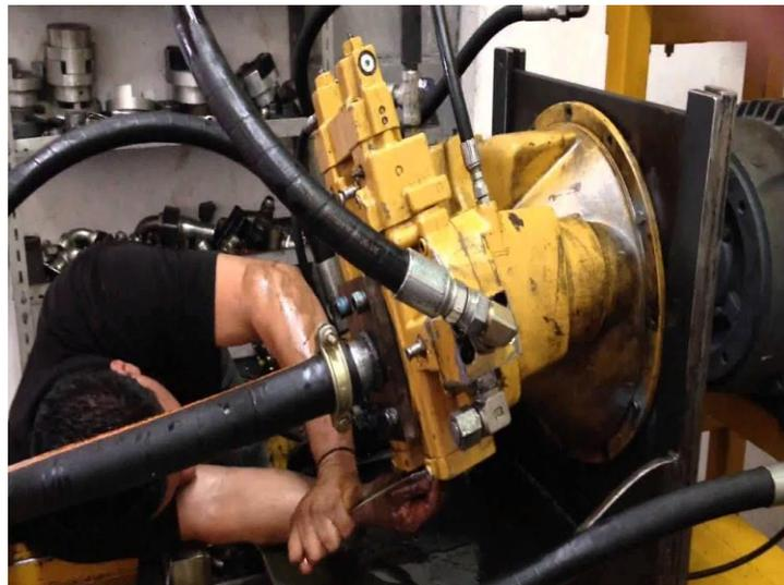
*Nota.* En la imagen se muestra la purga de una bomba hidráulica CAT.
