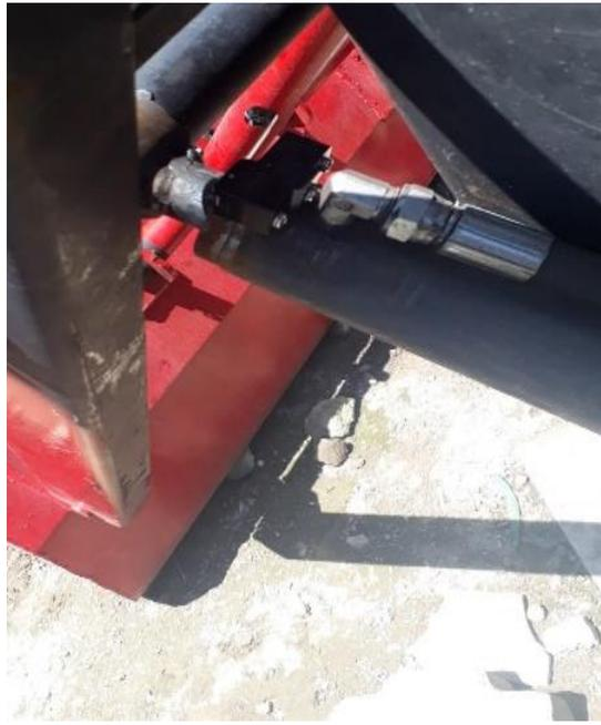
*Nota.* La presente imagen muestra el final de carrera colocado en el cilindro de los brazos delanteros de la pala mecánica.
