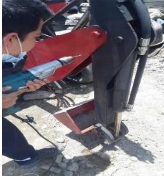
*Nota.* La fotografía muestra la perforación que se realizó a las herramientas del banco de entrenamiento de maquinaria pesada con el fin de la colocación del final de carrera.
