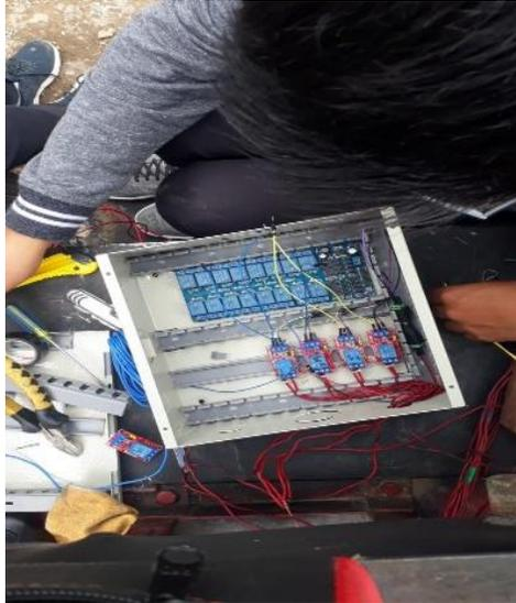
*Nota.* La fotografía indica el montaje de los relés para el control de las herramientas y tracción, pulsadores y finales de carrera.
