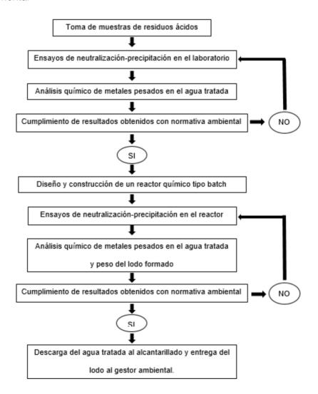
Nota. El gráfico muestra el procedimiento llevado a cabo a escala de laboratorio y en el reactor químico.
