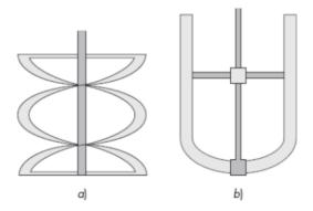
Nota. El gráfico muestra los tipos de agitadores para viscosidades altas, siendo a) agitador de cinta de doble trayectoria helicoidal; b) agitador de ancla. Tomado de *Diseño y construcción de un reactor tipo batch para el Laboratorio de Operaciones Unitarias de la Facultad de Ciencias Ambientales de la Universidad Internacional SEK.*, por Coronel, 2014.
