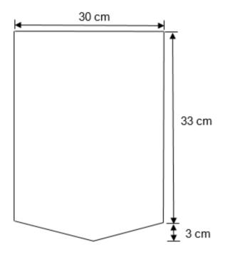
Nota. La figura muestra las dimensiones del prototipo del reactor químico para tratar 20 litros de desecho.
