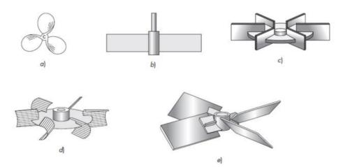
Nota. El gráfico muestra los tipos de agitadores para viscosidades moderadas, siendo a) agitador marino de tres palas; b) turbina simple de pala recta; c) turbina de disco; d) agitador de pala cóncava; e) turbina de pala inclinada. Tomado de *Diseño y construcción de un reactor tipo batch para el Laboratorio de Operaciones Unitarias de la Facultad de Ciencias Ambientales de la Universidad Internacional SEK.*, por Coronel, 2014.
