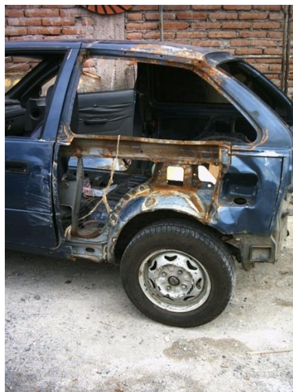
Figura Nº 1.1 Corrosión en un automóvil
