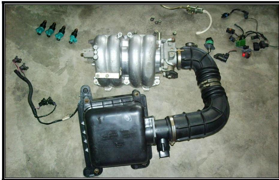
Figura 3.3 Elementos que conforman el Sistema de Inyección Electrónica
