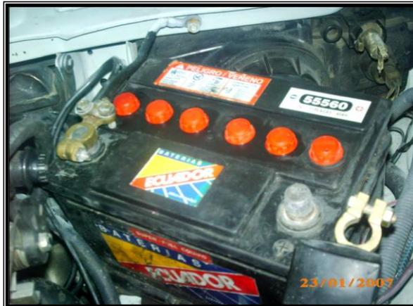
Figura 3.11 Desconexión y desmontaje de la batería de acumuladores
