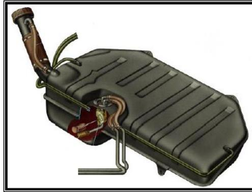
**Figura 1.22 Depósito de Combustible**
