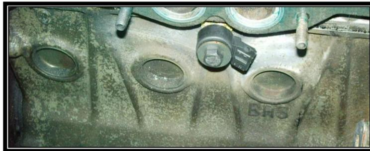
**Figura 3.54 Instalación del sensor KS**
