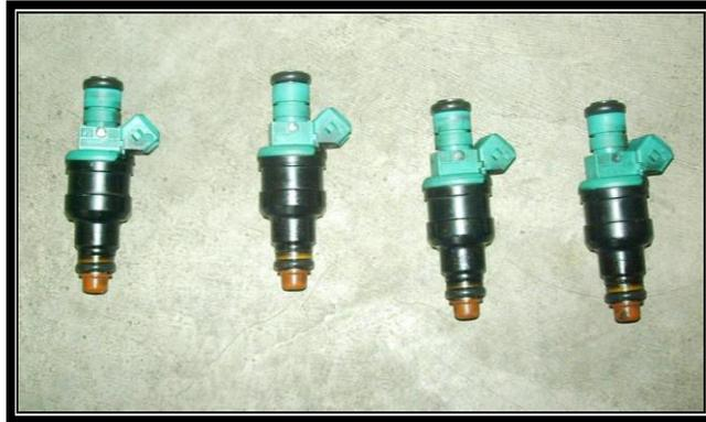
**Figura 1.27 Inyectores eléctricos**
