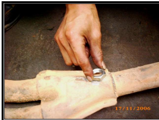
**Figura 3.44 Selección del lugar para la instalación del sensor HEGO**
