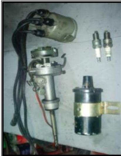
**Figura 3.20 Elementos del sistema de encendido convencional suprimidos**
