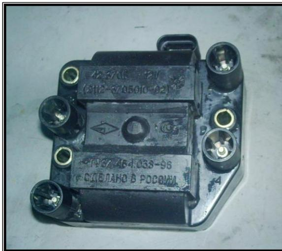
**Figura 1.33 Bobina de 4 salidas de Alta Tensión**
