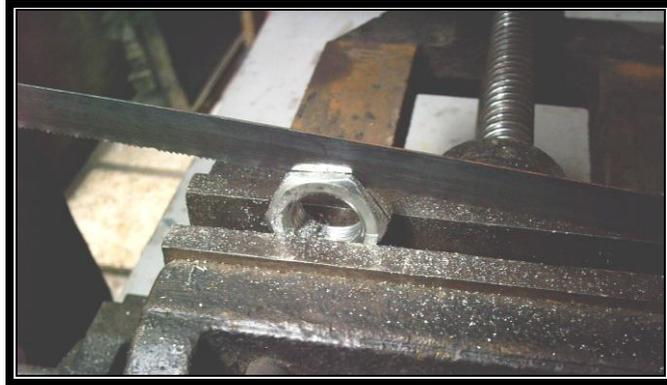
**Figura 3.41 Reducción del espesor de la tuerca base**
