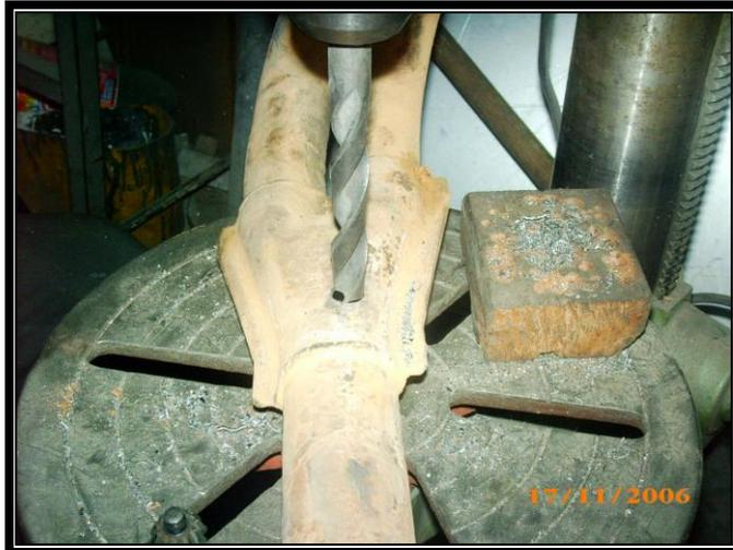
**Figura 3.45 Perforación del tubo de escape**
