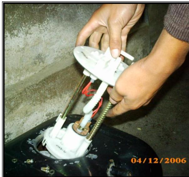
**Figura 3.51** Instalación de la bomba de combustible
