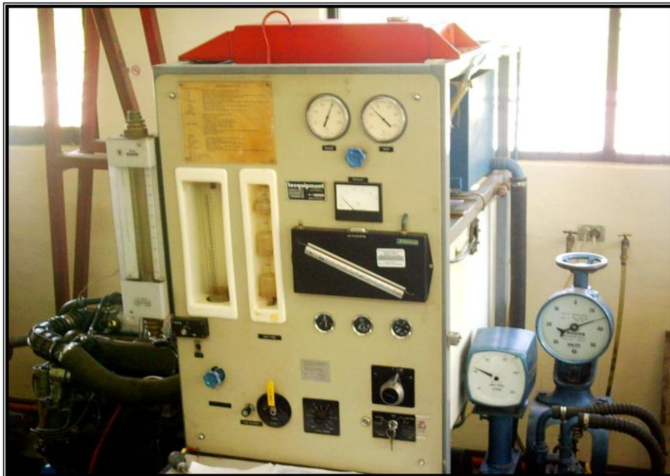
**Figura 4.2 Panel de control del dinamómetro**
