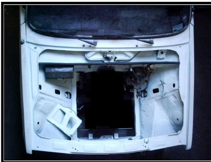
**Figura 3.19** Habitáculo vacío del motor
