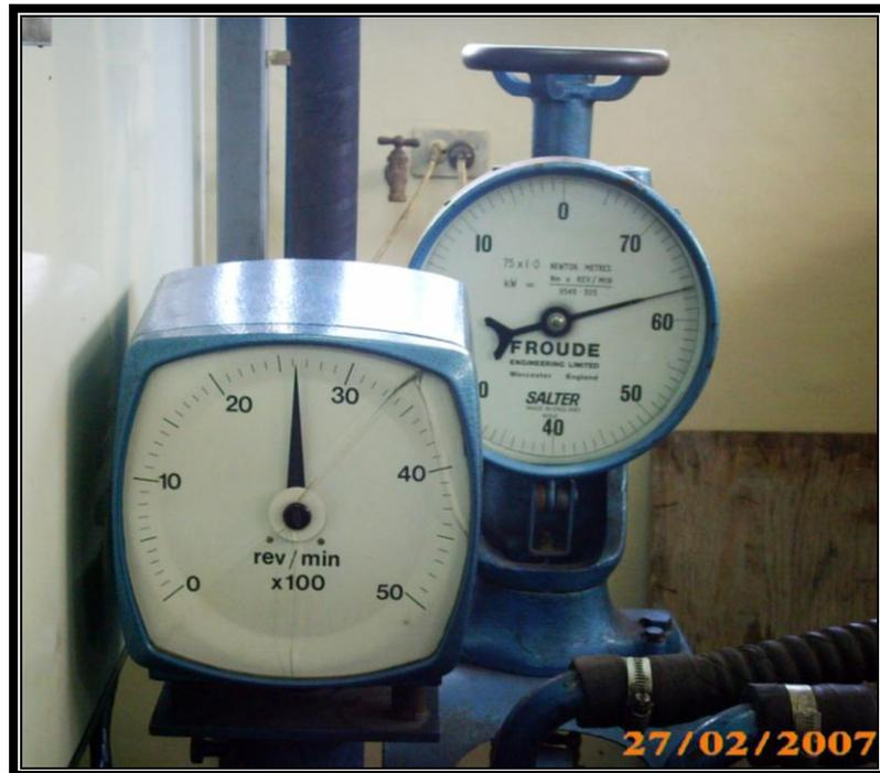
Figura 4.7 Lectura del torque máximo obtenido con el sistema convencional
