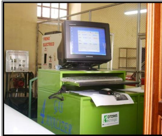
**Figura 4.3 Analizador de Gases Computarizado *Gascheck***
