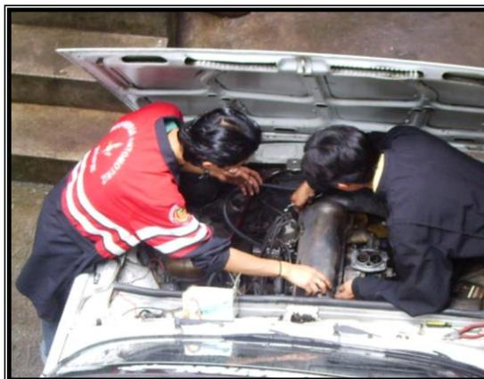
**Figura 3.15 Desmontaje de la tapa de válvulas**
