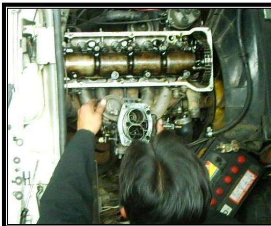
**Figura 3.14 Desmontaje del carburador**
