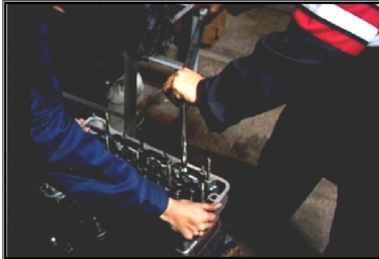
**Figura 3.55 Torque del cabezote**
