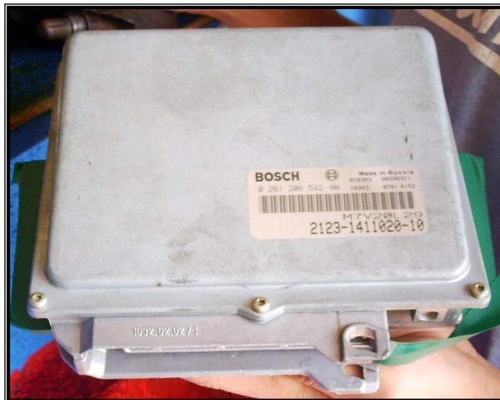
Figura 1.4 Módulo de Control del Tren de Potencia (PCM)
