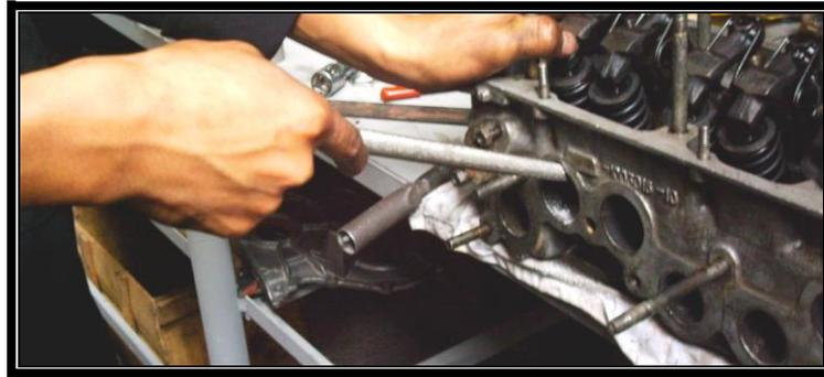
**Figura 3.33 Limado con lima circular**
