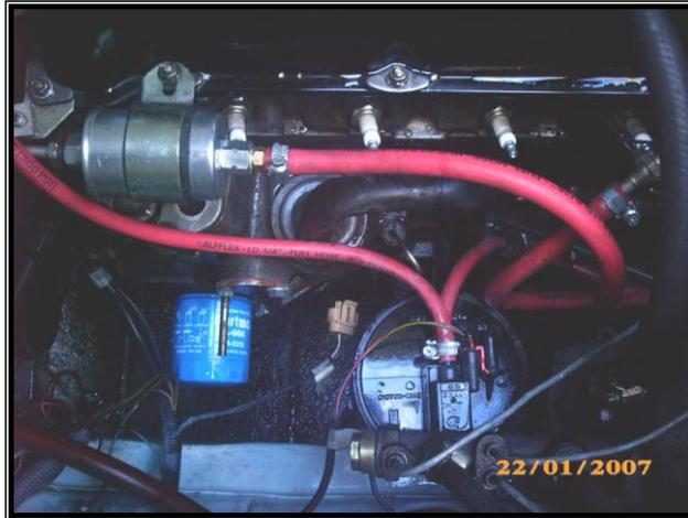
**Figura 3.62 Sistema de alimentación de combustible instalado**
