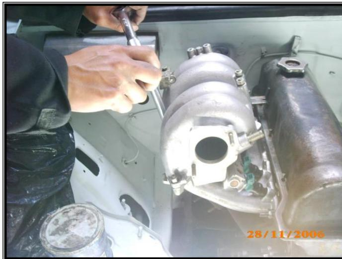
**Figura 3.59 Fijación de la carcasa del múltiple de admisión**
