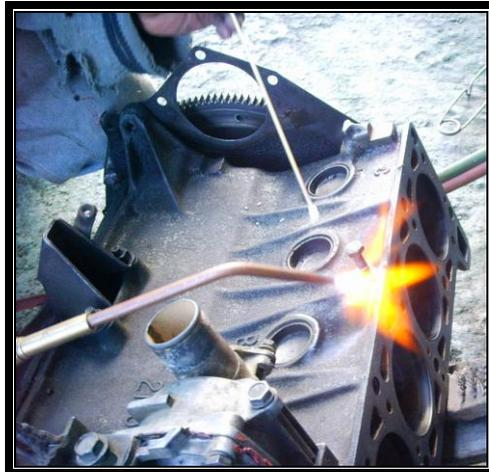
**Figura 3.24 Proceso de soldadura de la base para el sensor KS**
