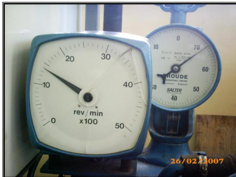
Figura 4.17 Lectura del torque máximo obtenido con el sistema MPFI
