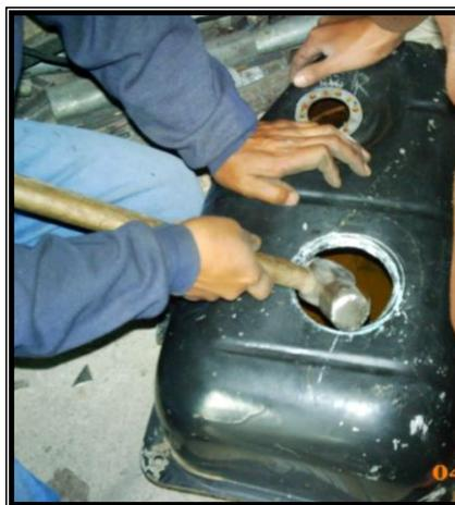
**Figura 3.49 Doblado del contorno del orificio**
