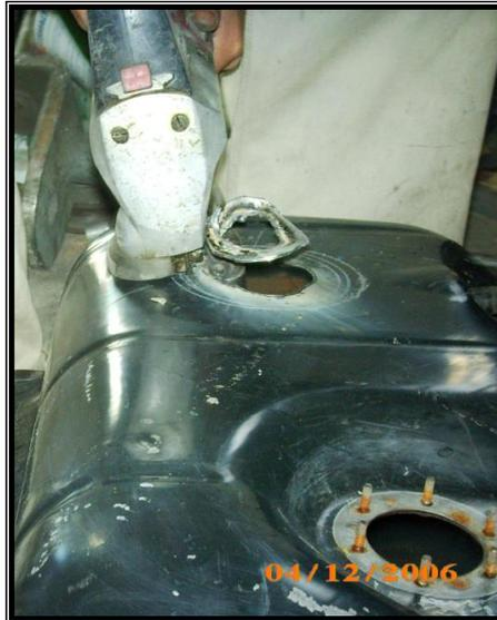
**Figura 3.48 Calado del orificio para alojamiento de la bomba de combustible**
