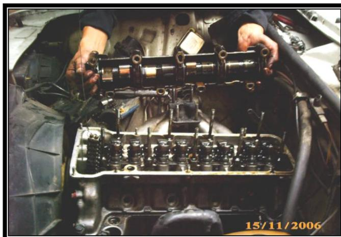
**Figura 3.17 Desmontaje del cabezote**
