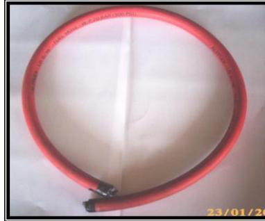
**Figura 1.24 Manguera de alta presión de combustible**
