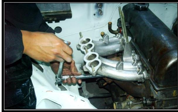
**Figura 3.39 Comprobación de sujeción del múltiple de admisión**
