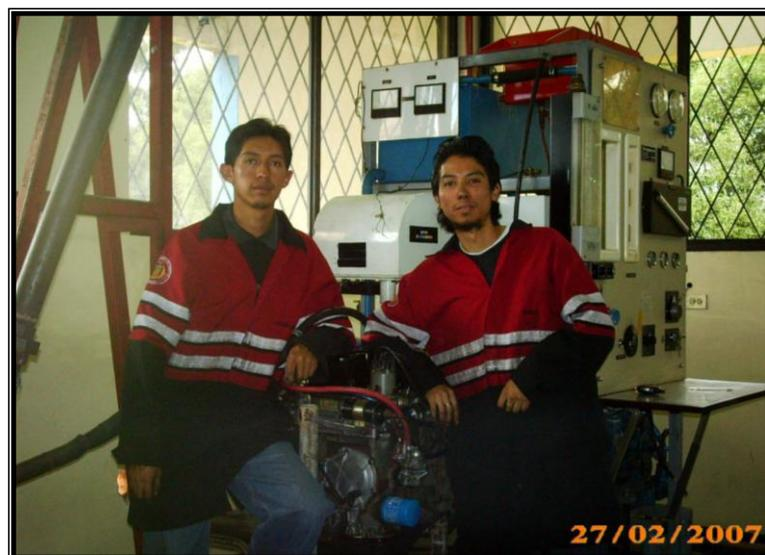
**Figura 4.1 Dinamómetro con freno hidráulico**
