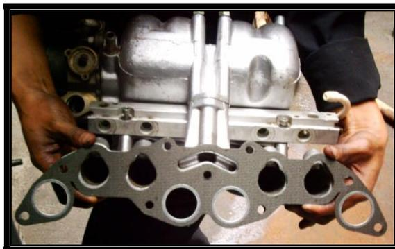
Figura 3.27 Verificación de la sección transversal de paso
