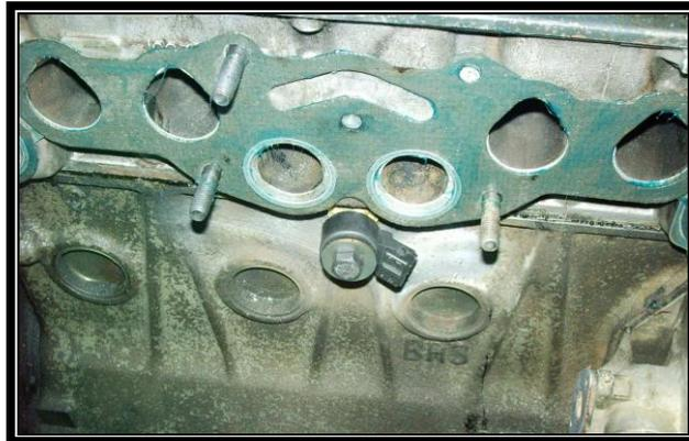
**Figura 3.26 Instalación del sensor KS**
