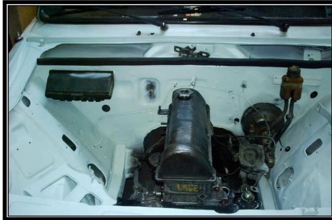
**Figura 3.56 Montaje del motor en su habitáculo**
