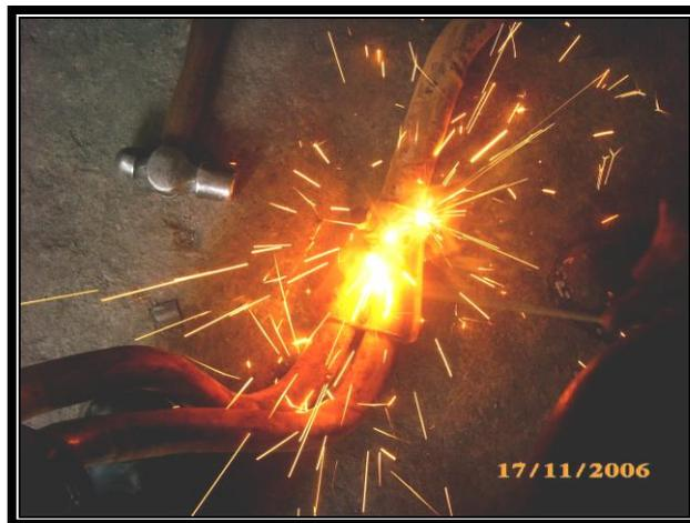
**Figura 3.46 Soldadura de la tuerca base**
