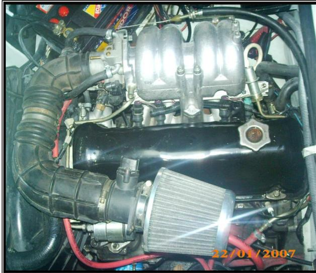
**Figura 3.60 Sistema de admisión de aire instalado**
