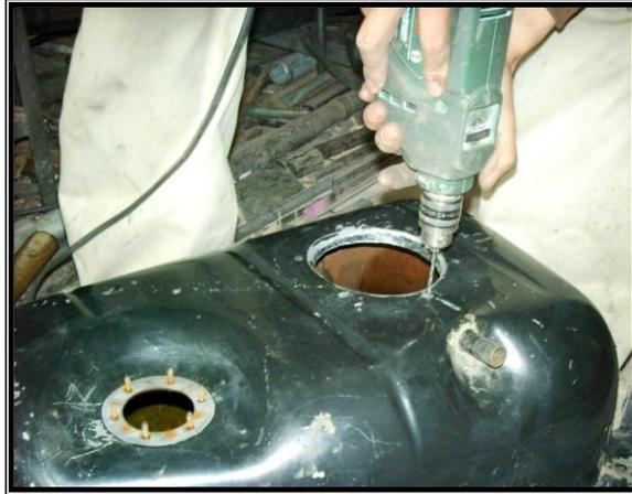
**Figura 3.50** Perforación de puntos de sujeción de la bomba
