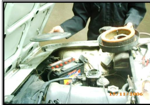
**Figura 3.13 Desmontaje depurador**
