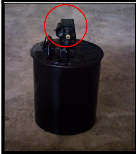
Figura 1.29 Válvula electromagnética de purga (Cánister)
