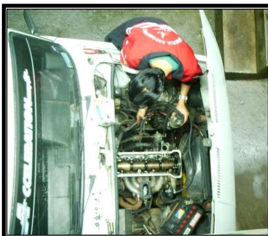
**Figura 3.16 Desmontaje del distribuidor de encendido**
