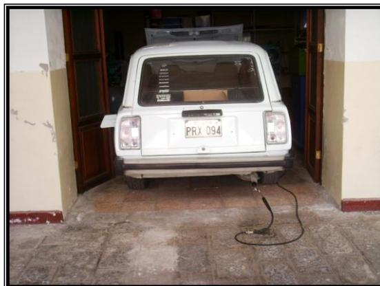
**Figura 4.10 Instalación del Analizador de gases**
