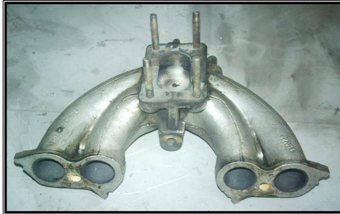
**Figura 3.23 Elemento del sistema de admisión de aire suprimido**
