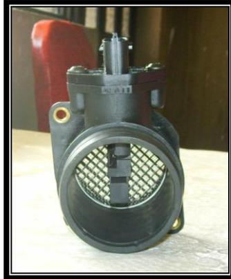
**Figura 1.12 Sensor de Flujo Másico de Aire (MAF)**
