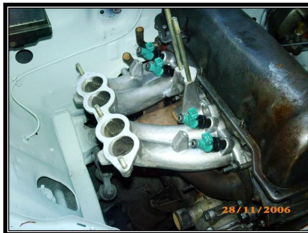
**Figura 3.57 Montaje del múltiple de admisión e inyectores**
