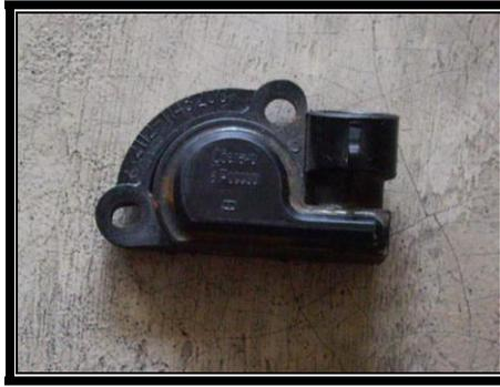
Figura 1.13 Sensor de Posición del Estrangulador
