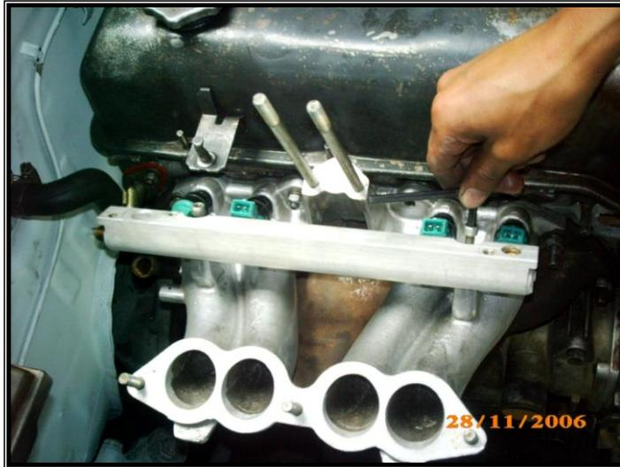
**Figura 3.58 Montaje del riel de distribución**
