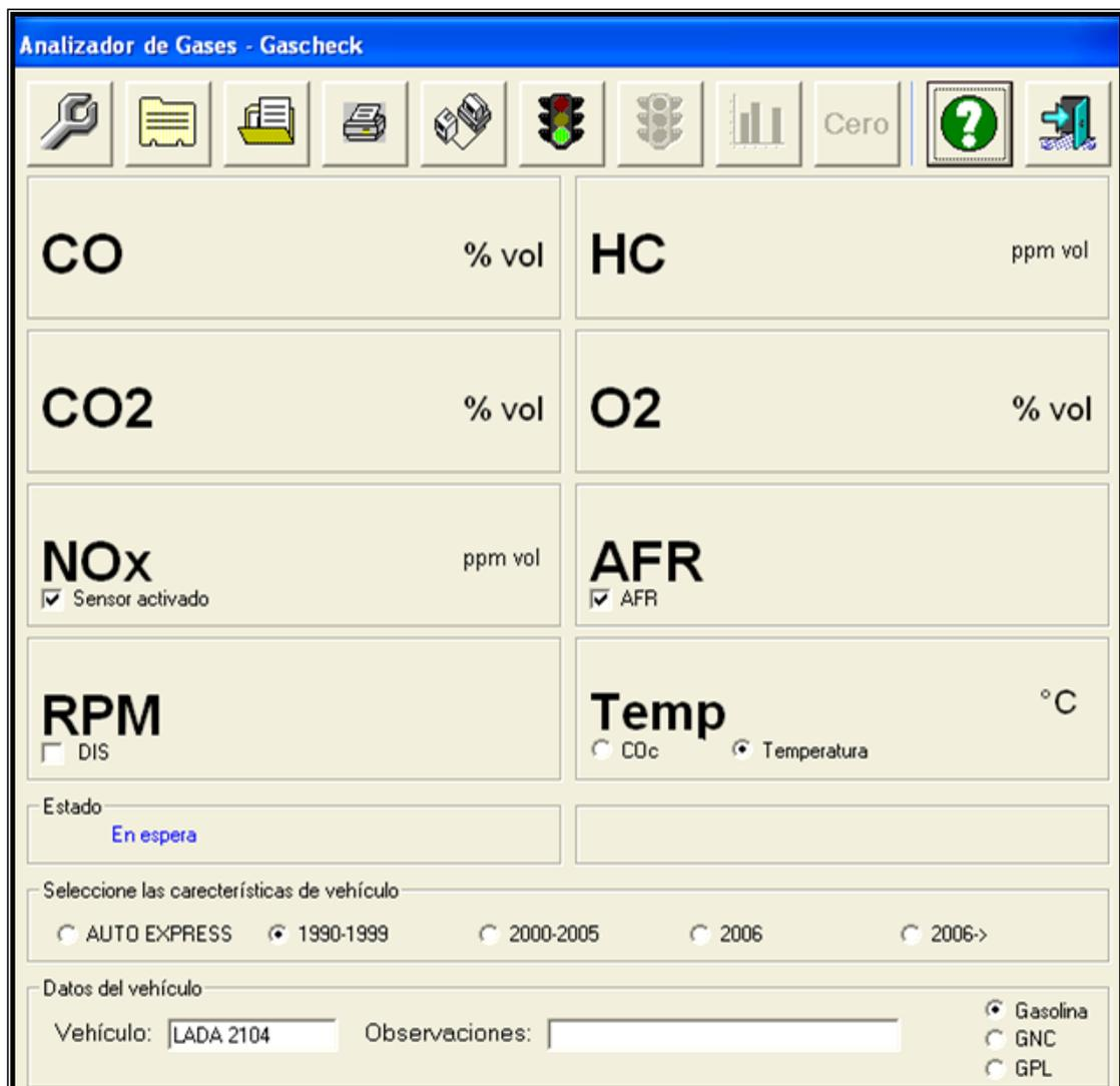
Figura 4.4 Pantalla principal del Analizador de Gases *Gascheck*
