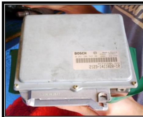
Figura 3.4 Módulo de Control de Potencia (PCM)
