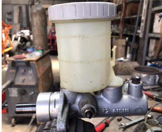
En este caso poseemos una bomba de freno de doble entrada la cual permitirá el acceso de las 2 cañerías referente e cada lado del vehículo, la misma se verifico es suficiente para abastecer todo el sistema de frenos.
