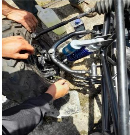
**Verificación de fugas en las cañerías hidráulicas.**
