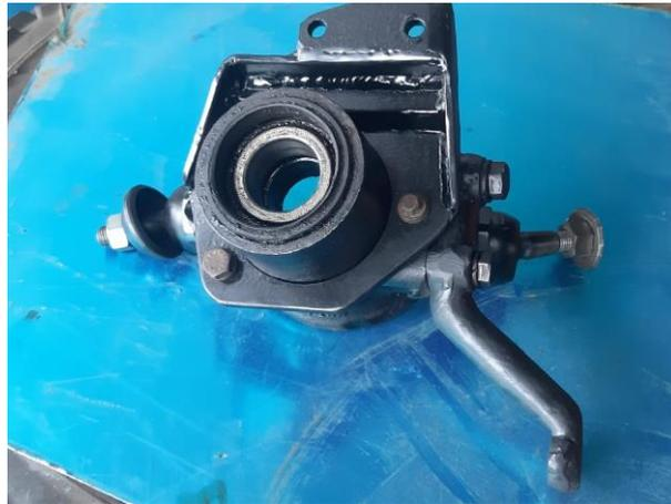
Formados los implementos necesarios para el correcto posicionamiento del disco de frenos los unimos y aseguramos, el disco ira ubicado entre la parte trasera de la manzana y la mangueta.
