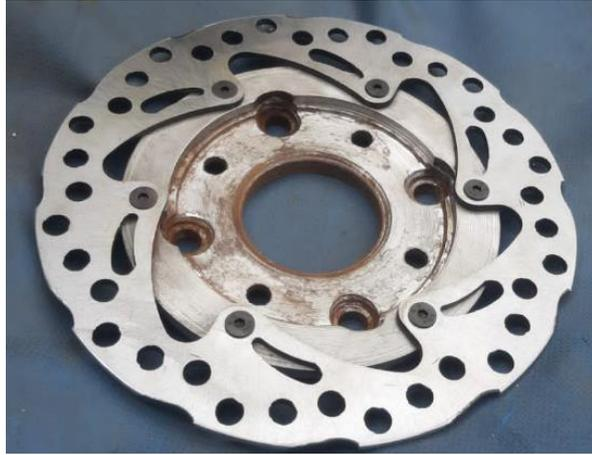
Se utilizará discos de frenos perforados de motocicleta ya que son los más aptos y que se pueden acoplar de mejor manera a la mordaza y brindar seguridad al manejar el vehículo el espesor de los mismos es de 0,45 mm.
