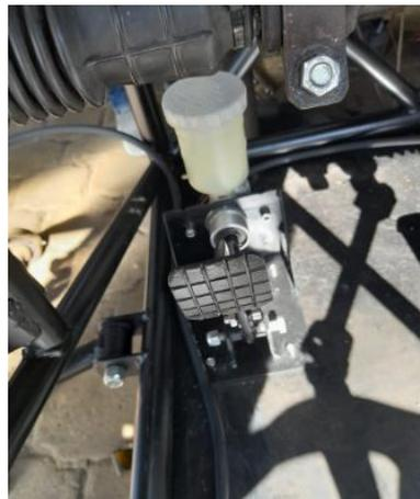
En la bomba por motivo de la existencia de más salidas de líquido de frenos, es necesario utilizar tapones los cuales son realizados con ayuda de pernos que son recortados y adaptados de acuerdo a la rosta de entrada de la bomba para de esta manera evitar las fugas por medio de la propia bomba.
