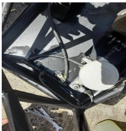
*Nota.* El derrame de líquido de frenos se limpió tan pronto se detectó la fuga con ayuda de agua y guapos estés porque podría dañar otros elementos del prototipo en caso de llegar a tener contacto.
