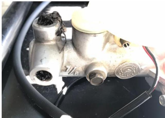
Para esto fue necesario la creación de una “T” la cual permitiría activar el sistema de freno de la parte delantera ya que se tiene que desplazar líquido de frenos en la misma proporción a las llantas delanteras.
