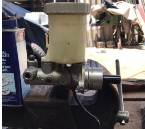
La instalación de esta esta es lineal a la del pedal de freno esto debido a que su accionamiento depende de este último, se ubica en la parte delantera a 8 cm de distancia con respecto a la estructura frontal y va sujeta al conjunto de platina formado para este sistema en el cual se utiliza pernos con entrada de hexagonal #5 y tuercas #8.
