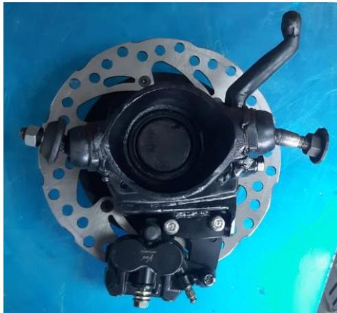
Ahora tenemos el disco de freno acoplado a la mangueta a la manzana y a la mordaza, de esta manera tenemos el mecanismo completo el cual en su momento ira acoplado a los brazos de la estructura y a su vez con el eje y el amortiguador.
