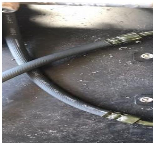
Utilizaremos 2 cañerías ya que poseemos una bomba de freno de doble entrada y se
