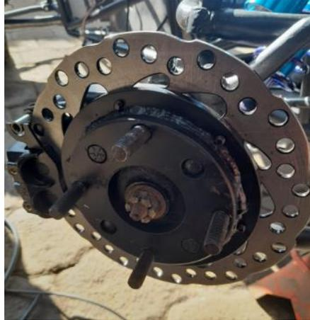
Finalmente instalamos este mecanismo en la base realizada para que se acople de manera correcta y posteriormente poder sujetarlos con pernos y tuercas #19, en el caso de los amortiguadores, brazos de la estructura y terminales que permiten un ajuste más complementario entre todos los sistemas se colocaron tuercas de seguridad en todos ellos para la mayor seguridad al momento de manejo ya que las mismas no permitirán el retroceso o salida de ninguno de los pernos.
