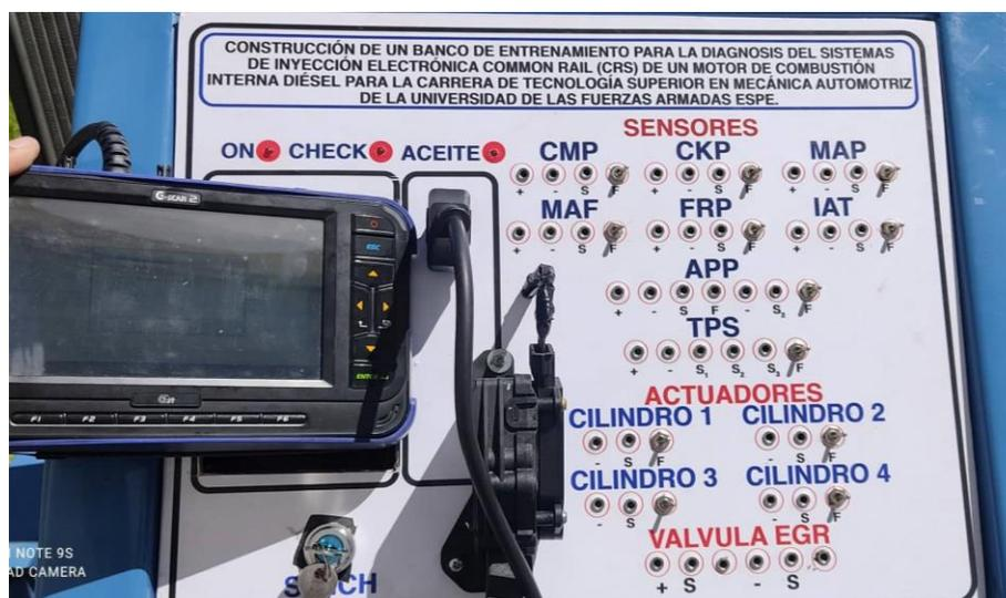
*Nota.* La gráfica representa la conexión mediante OBD II con el escáner automotriz.
