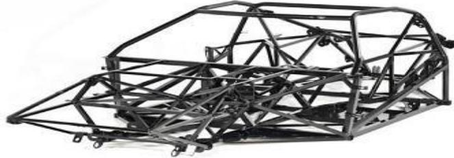
*Nota.* En la figura 6 tenemos un bastidor tubular el cual fue fabricado para tener estructuras más ligeras.
