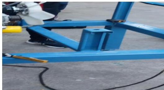
*Nota.* En la figura 25 se hizo de cortar una de las correas en las medidas que pedía el plano con el cual se procedió a realizar la base de soporte del radiador el cual también se le realizó las perforaciones para la sujeción del radiador.
