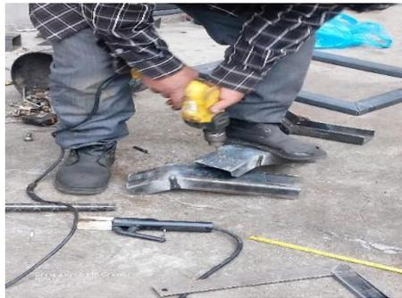
*Nota.* En la figura 26 como se puede observar se realizó las perforaciones para la sujeción de los pernos con el motor y se realizó la respectiva medición.
