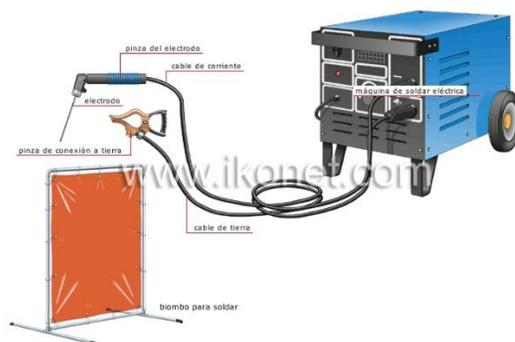
*Nota.* Aquí podemos observar el equipo de soldadura SMAW el más utilizados para soldaduras.
