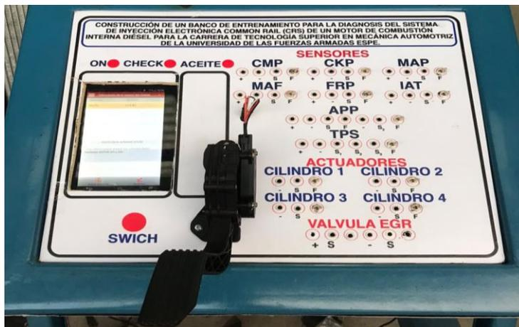
*Nota.* En la figura 39 se muestra el tablero de instrumentos donde podemos observar y controlar el estado de funcionamiento de los diferentes sensores.
