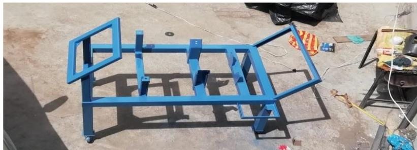
*Nota.* En la figura 29 como podemos observar tenemos el bastidor terminado con sus partes respectivas que van ser utilizadas por el motor y sus partes auxiliares.
