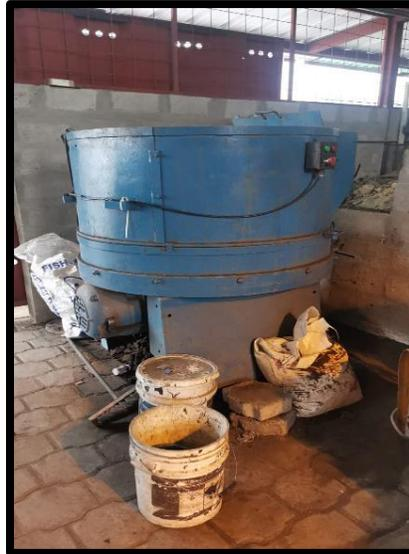
El molino contiene un rodillo que permite refinar la arena para obtener el tamaño de grano adecuado.
