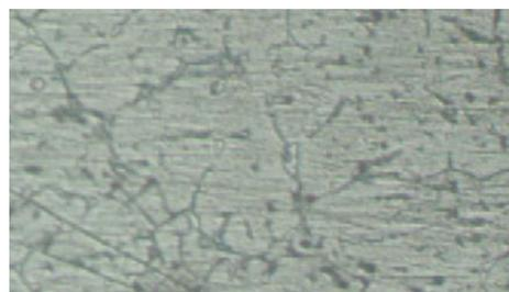
En la Tabla 13 se puede observar las fotografías microestructurales del material mejorado en el cual se le realizó el proceso de desgasificación, se puede identificar que el material es mucho más compacto por lo que tendrá una mayor resistencia a la tracción y una baja probabilidad de fisuras.
