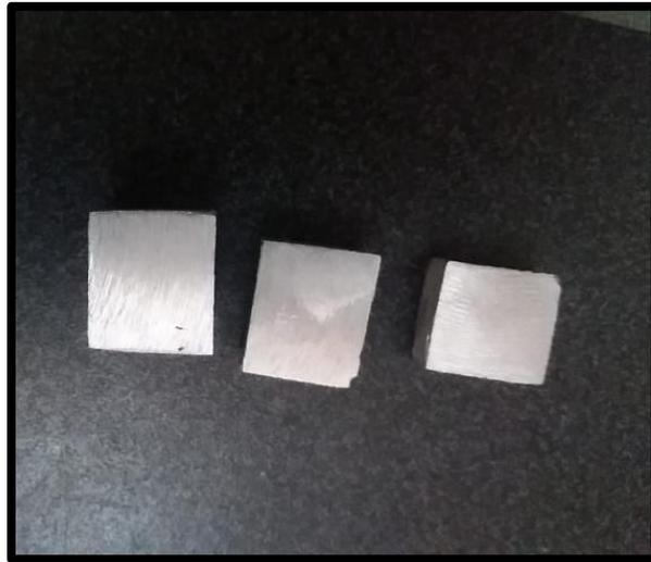
En caso del cilindro y las probetas para ensayos de compresión se utilizó un torno el cual nos permite desbastar el espesor del cilindro hasta obtener el diámetro específico de las probetas.
