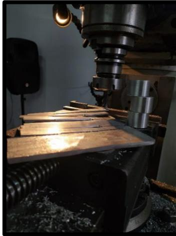
Una vez que las dimensiones y la forma de la probeta fueron establecidas, se utiliza el proceso de manufactura por arranque de viruta en la misma fresadora para de esta manera darle un pulido a la probeta y dejarla de el espesor requerido.
