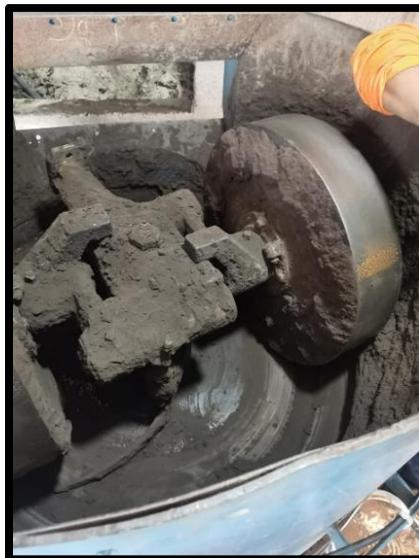
Los rodillos además de moler y refinar la arena de sílice mezclan la bentonita y el agua para obtener la arena utilizada en los moldes finales.
