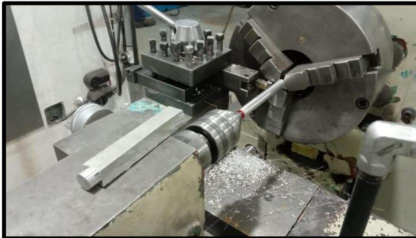
Teniendo en cuenta el diámetro requerido se procede a cortar el cilindro a la longitud deseada, para posteriormente refrentar las caras y obtener probetas totalmente rectas en sus superficies superior e inferior con lo cual nos ayudara a una estabilidad correcta al momento de utilizar la máquina de ensayos de compresión.
