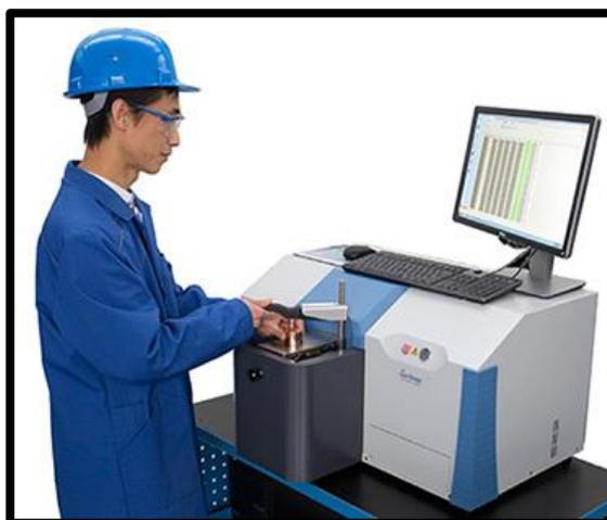
*Nota.* Adaptado de Espectrómetro de emisión óptica (OES), por PANATEC,
