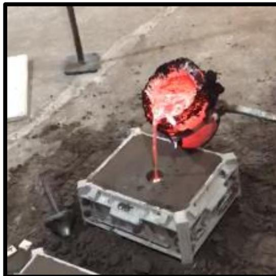
Una vez que la colada se ha vaciado en el molde se deja enfriar por unos minutos para que se solidifique el material fundido en el molde y obtener la pieza resultante desmoldando el bastidor y extrayendo dicha pieza conforme a la estructura y forma requerida.
