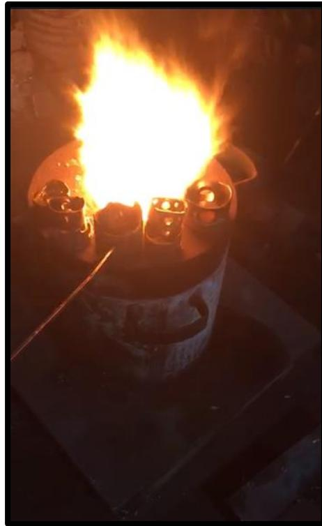
Teniendo en cuenta un tiempo de 10 minutos y verificando que el aluminio se ha fundido en su totalidad se retira el crisol del horno para posteriormente verter la colada en los moldes, hay que tener en cuenta que al momento de la fundición existen impurezas del material las cuales se presentan como forma de “rebaba” en la superficie de la colada.
