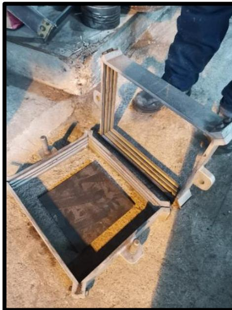
El bastidor estándar tiene un tamaño proporcional que abarca el núcleo en su totalidad, para evitar que la arena se pegue al núcleo al momento de realizar la compactación del molde es necesario cubrir la superficie del mismo con una capa generosa de grafito, evitando que se generen poros en las paredes de la cavidad del núcleo al momento de dividir el bastidor y extraerlo, para el posterior proceso de vertido de material.
